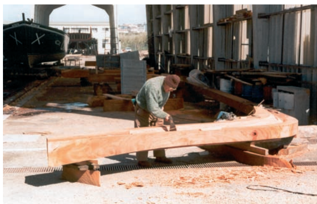
Estaleiros Postiga e Feiteira Lda. Carpinteiro de enxó afeioa o alefrez da roda de proa de uma nova embarcação. Na carreira a replica da lancha "Fé em Deus" para reparação. 1999
