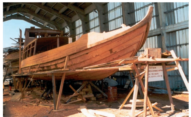
Estaleiros Navais Samuel e Filhos Lda. Construção de um Barco Rabelo para turismo náutico no rio Douro. Fotografado em 1999
