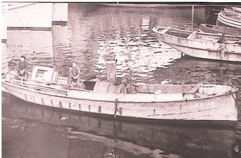
San Vicente, "merlucera" dos anos 30, empregada tamén na pesca costeira, con 10,6 m de eslora, liñas tradicionais e estrutura de vareta reforzada. Foi construída en 1933 por A. Aseguinolaza en Hondarribia e donada al Untzi Museoa en xuño de 1993.
