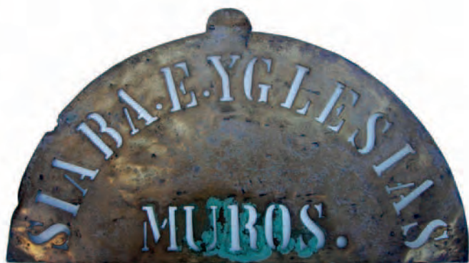
Peza de latón utilizada para marcar os tabais co logo de Siaba e Iglesias
