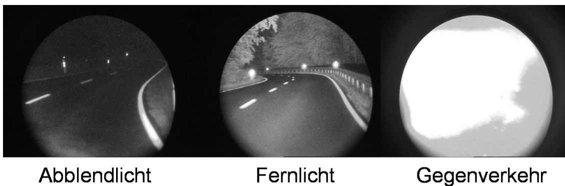
Bild 2.3 : Bilder eines Restlichtverstärkers in verschiedenen Beleuchtungssituationen
