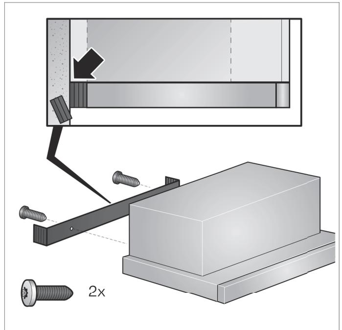
5. Gerät wieder einhängen, ausrichten und festschrauben. Alle Schrauben vorsichtig anziehen.
