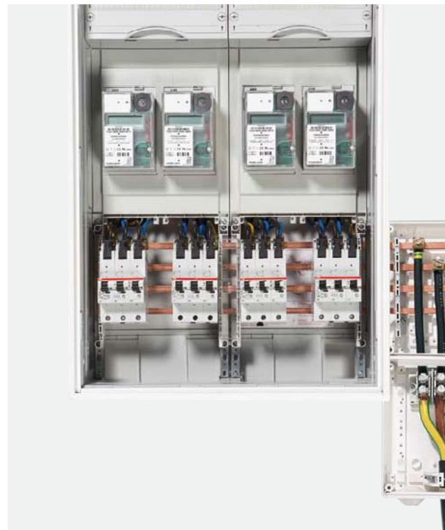
EK230 als Mitteneinspeisegehäuse zwischen zwei A-Schränken. Hierzu Sammelschienensatz gegen Mitteneinspeisesatz ZX430 (Zubehör) austauschen. Verbindungsleitung NSGAFÖU 50, 70 oder 95 mm 2 (Zubehör)
