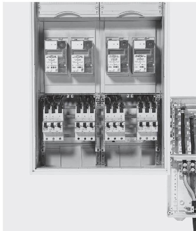
EK230 als Mitteneinspeisegehäuse zwischen zwei A-Schränken. Hierzu Sammelschienensatz gegen Mitteneinspeisesatz ZX430 (Zubehör) austauschen. Verbindungsleitung NSGAFÖU 50, 70 oder 95 mm<sup>2</sup> (Zubehör)
