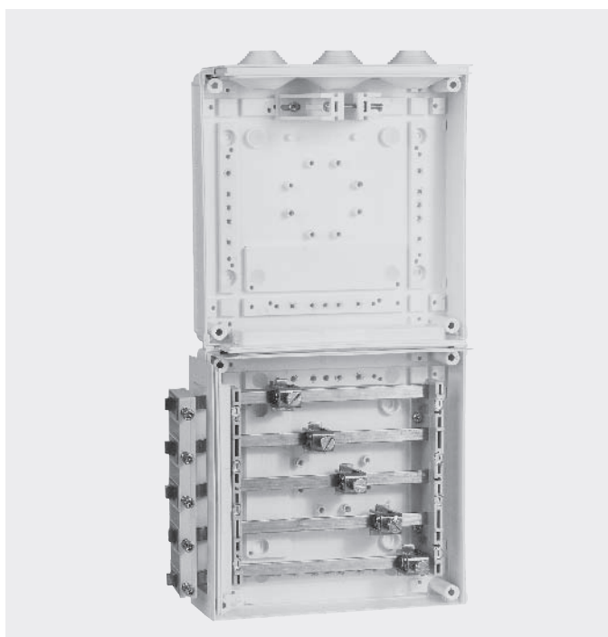
Einspeisegehäuse EK230 mit Sammelschienenensystem Cu 12 x 5 mm, 5-polig zur seitlichen Einspeisung rechts oder links am Zählerschrank. (Sammelschienenanschlussklemmen Zubehör)
