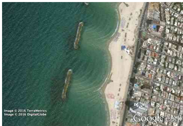
Rysunek 4.2 Na skutek dyfrakcji fale oceaniczne, wchodząc przez otwór w falochronie, mogą się rozprzestrzeniać po zatoce. Źródło: modyfikacja danych z map Google Earth
