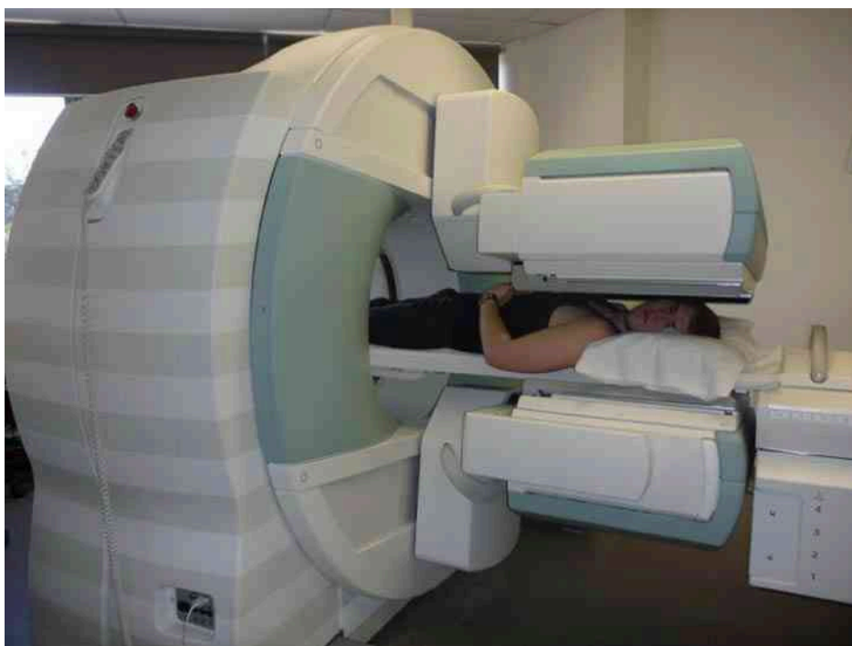
Rysunek 10.27 Urządzenie SPECT tworzy obraz ludzkiego ciała, wykorzystując promieniowanie emitowane przez radiofarmaceutyk. Źródło: „Woldo”/Wikimedia Commons
