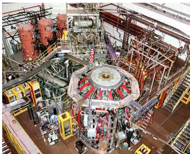
Rysunek 5.25 NSTX (ang. National Spherical Torus Experiment) to reaktor termojądrowy, w którym izotopy wodoru poddaje się syntezie jądrowej, w wyniku której powstaje hel. W tym układzie stosunkowo mała masa zostaje zamieniona w dużą ilość energii.
