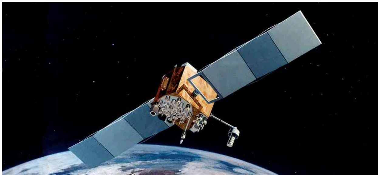
Rysunek 5.1 Szczególna teoria względności wyjaśnia, dlaczego na Ziemi czas płynie inaczej niż dla szybko poruszającego się satelity systemu GPS (Global Positioning System). Odbiorniki nawigacji satelitarnej znajdujące się w samochodach nie mogłyby poprawnie określać swojej pozycji na Ziemi, nie biorąc pod uwagę tej rozbieżności. Źródło: USAF
