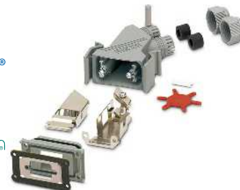
D-SUB csatlakozó készlet IP67, tartalma Lengő tokozat, falra szerelhető keret és tartozék, árnyékolt kivitel
