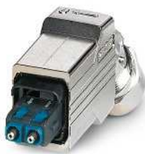
SC-RJ dugaszolható csatlakozó, kábeleágazás lefelé, 980/1000 µm-es polimerszálhoz
