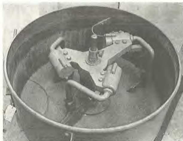
Fig. 69. I en tvangsblender rores materialerne sammen af de viste skovle, en blandingemetode, som er mere effektiv end fritfaldsblanderens. Men fritfaldsblanderen benyttes næsten overalt, fordi den er mere bekvem at arbejde med og mere robust.
