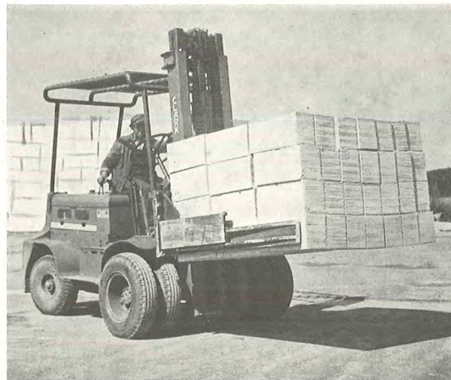
Fig. 68. Gaffeltruck under transport af gasbetonsten. Den er forsynet med en klem-anordning, der griber om og fastklemmer stables nederste lag sten.
