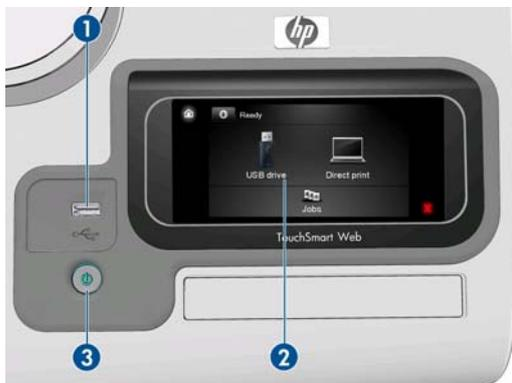
1. Ein High Speed USB-Hostanschluss zum Anschließen eines USB-Sticks, auf dem zu druckende Dateien zur Verfügung stehen können. Wenn ein USB-Stick eingesteckt wird, wird ein USB-Symbol
