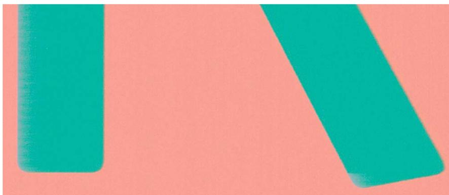
Wenn Objektkanten oder Linien unscharf oder zu hell gedruckt werden und der Schieberegler im Dialogfeld des Treibers bereits auf **Qualität** eingestellt ist, versuchen Sie es mit der benutzerdefinierten Druckqualitätsoption **Normal** (siehe [„Drucken“ auf Seite 52](#)).
