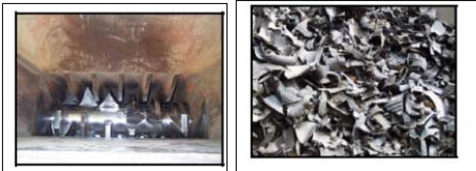
Figura 6.19: Imatge de les ganivetes de la trituradora principal i del pneumàtic triturat obtingut
