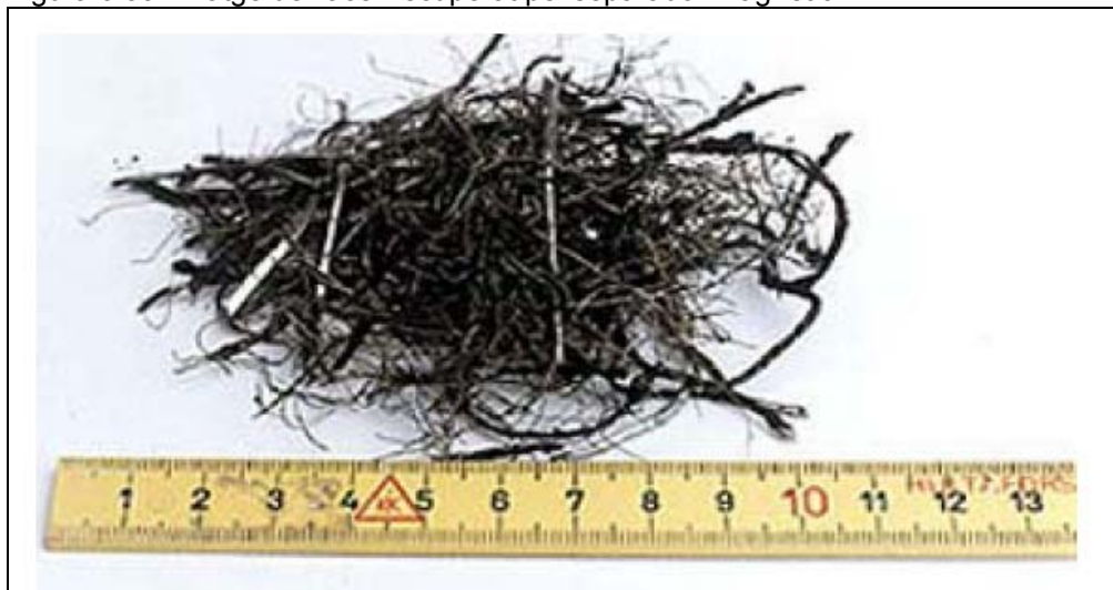
Figura 6.33: Imatge de l'acer recuperat pel separador magnètic
