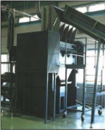
Figura 6.25: Imatge de la trituradora (heavy rasper) i de les seves ganivetes
