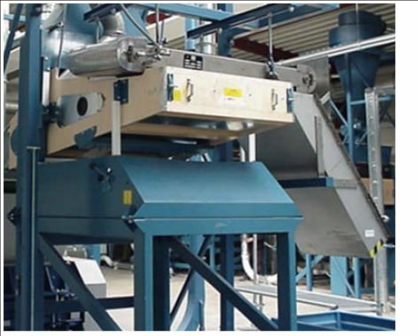
Figura 6.30: Imatge del separador magnètic
