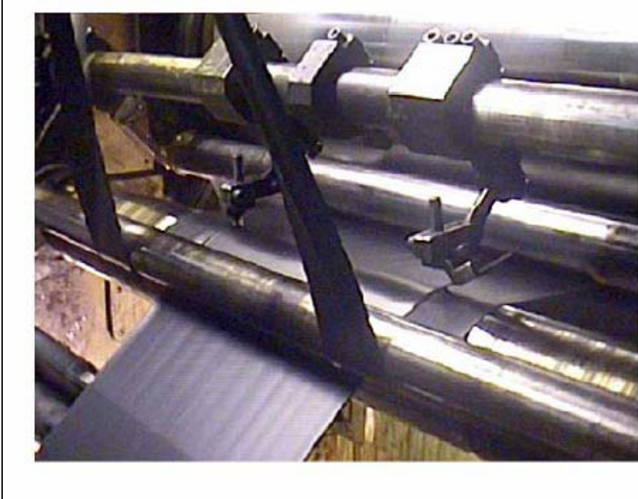
Figura 3.25: Mescla de cautxú sortint de la calàndria en forma de làmina o pel·lícula
