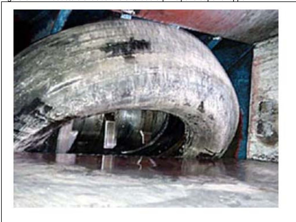
Figura 6.21: Producte d'entrada a la trituradora principal o super chopper
