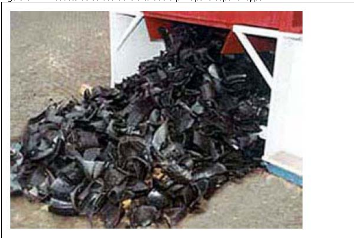
Figura 6.22: Producte de sortida de la trituradora principal o super chopper
