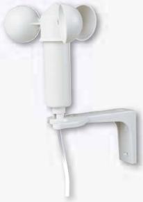
Der Windsensor WS erzeugt eine von der Drehzahl des Windrades abhängige Impulsfolge. Diese wird in einem nachgeschalteten Sensorrelais LRW12D ausgewertet.
