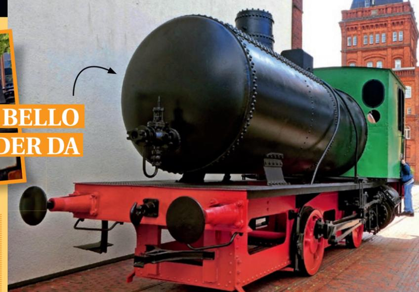
Dampflokomotive Bello ist und war eine solche eigentlich nie, sondern genau genommen eine Dampfspeicherlokomotive. Das heißt, dass sie im Gegensatz zur klassischen Dampflokomotive zwar auch durch Dampf angetrieben wurde, die-
