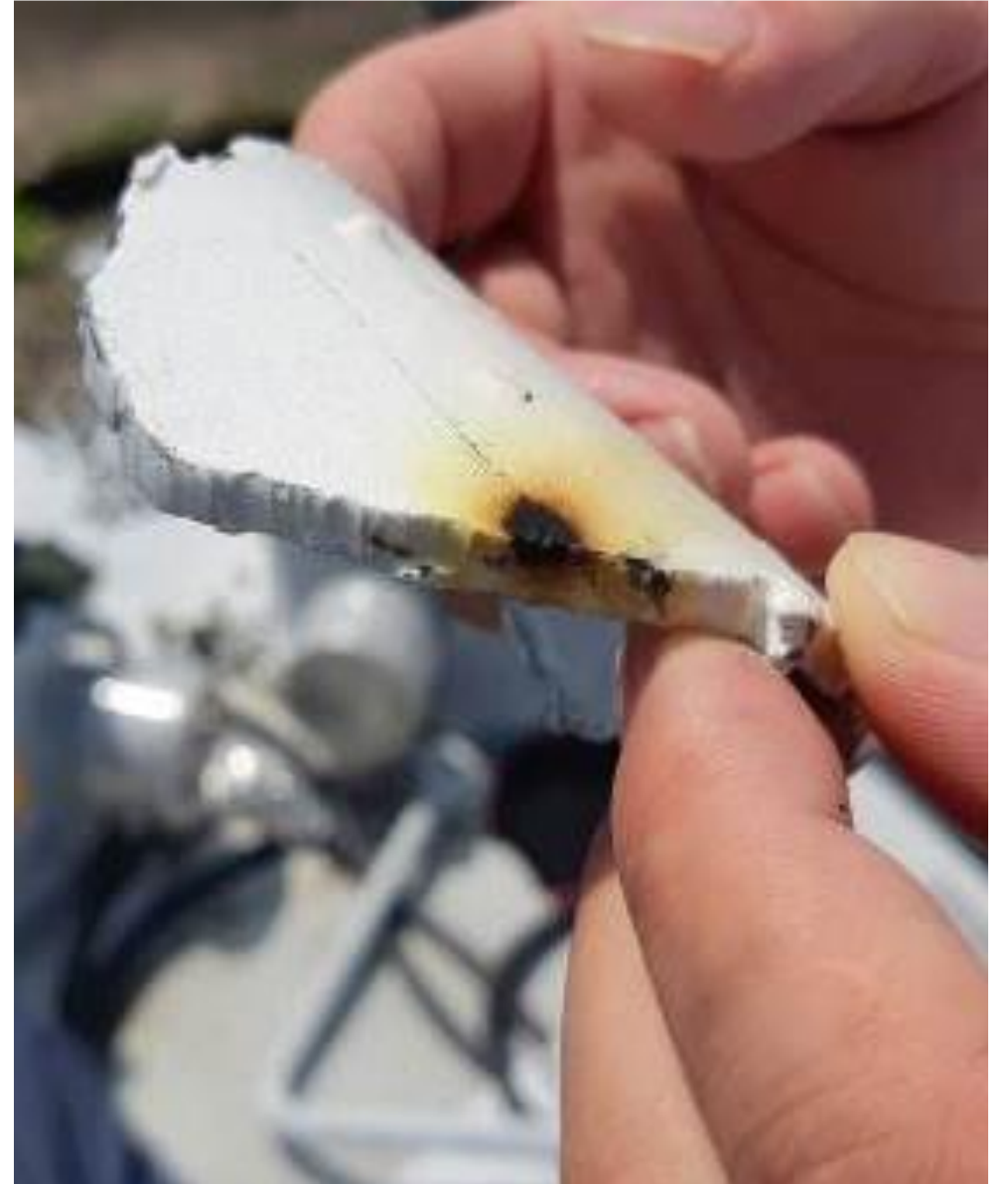
Ívnyomok a kis darab fém csővezetéken
