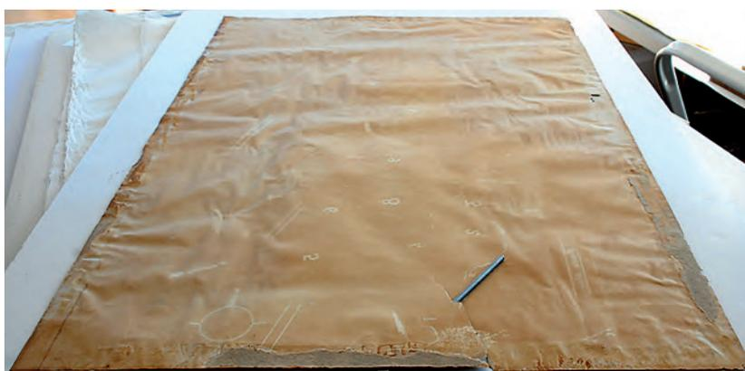
(Figura 11) Plano de Melilla, dibujo tinta china y acuarelas, de 1927, medidas 55,5 x 79 cm. Reverso, ondulaciones y grieta provocadas por un mal montaje de la obra con cinta adhesiva.
