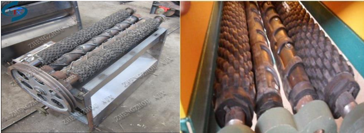
Gráfico 1. Rodillos peladores comerciales para variedad seco duro.
