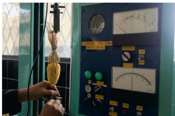
Gráfico 6. Ensayos de fuerza para arranque de la hoja de maíz.
