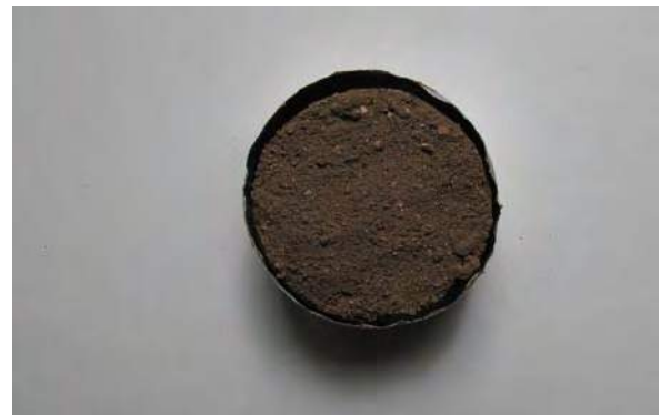
Figuras VI.23 y V.24. Ensayo de la pastilla en el que se puede apreciar la retracción de la muestra al secar (Procedencia gráfica: Díaz, I.).
