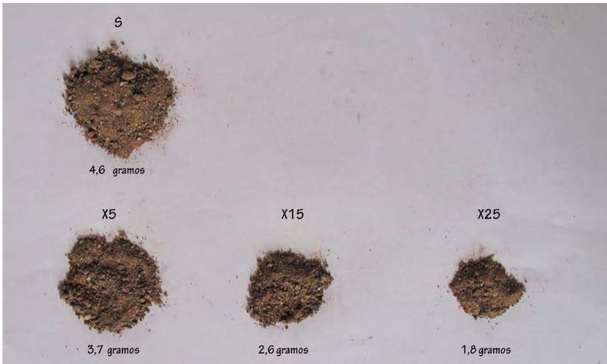
Figura VI.33. Granos extraídos a las probetas con disolución en xileno. (Procedencia gráfica: Díaz, I.).
