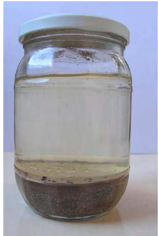
Figura VI.11. Test de la botella efectuado sobre la tierra extraída de la Casa del Deán (Procedencia gráfica: Díaz, I.).
