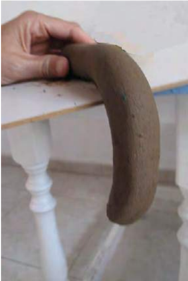
Figuras VI.14, y VI.15. Test del rollo que permite detectar una buena calidad de tierra para la construcción de tapial, debiendo romper para ello entre los 80 y 120 mm. (Procedencia gráfica: Díaz, I.).
