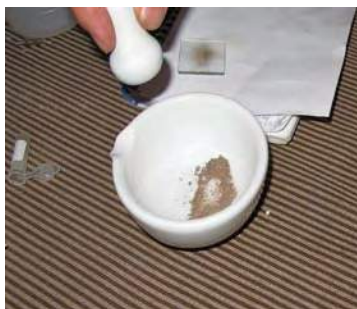
Figuras VII. 25. Molienda de la muestra para su posterior fijación. (Procedencia gráfica: Díaz, I.).
