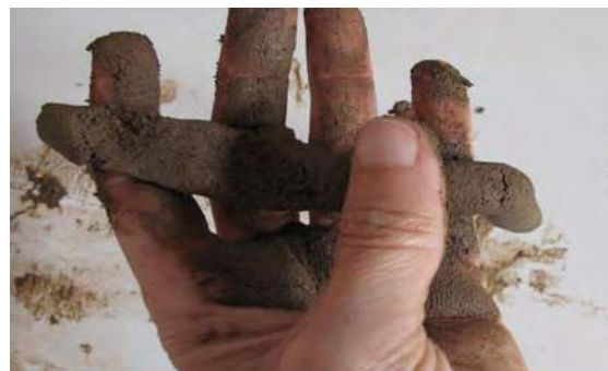
Figuras VI.19 y VI.20. Ensayo de la cinta; determina la plasticidad de un suelo. (Procedencia gráfica: Díaz, I.)
