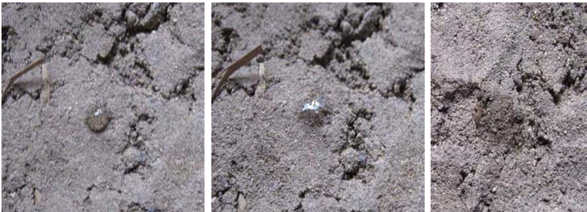
Figuras V.28, VI.29 y VI.30. Comportamiento de una gota desde que es aplicada en superficie hasta que pierde su brillo, correspondiente a la probeta X25. (Procedencia gráfica: Díaz, I.).
