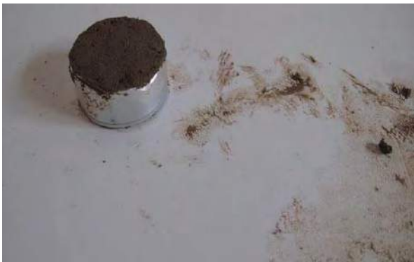
Figuras VI.23 y V.24. Ensayo de la pastilla en el que se puede apreciar la retracción de la muestra al secar (Procedencia gráfica: Díaz, I.).
