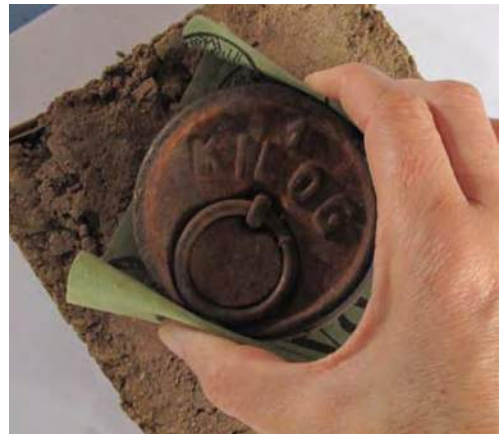
Figura VI.31. Proceso de ejecución del ensayo de abrasión. (Procedencia gráfica: Díaz, I.).
