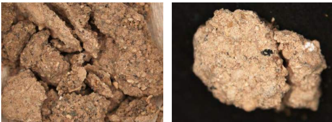
Figura 2. Imágenes de microscopía estereoscópica de los fragmentos de adobe tratados con el producto a base de látex de la especie Euphorbia Balsamífera diluido en xileno. Muestra M.2.
