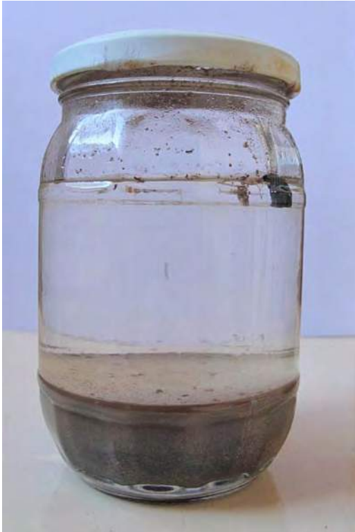
Figura VI.12. Test de la botella efectuado sobre la tierra extraída del Barranco Guiniguada (Procedencia gráfica: Díaz, I.).
