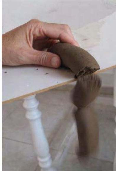
Figuras VI.14, y VI.15. Test del rollo que permite detectar una buena calidad de tierra para la construcción de tapial, debiendo romper para ello entre los 80 y 120 mm. (Procedencia gráfica: Díaz, I.).
