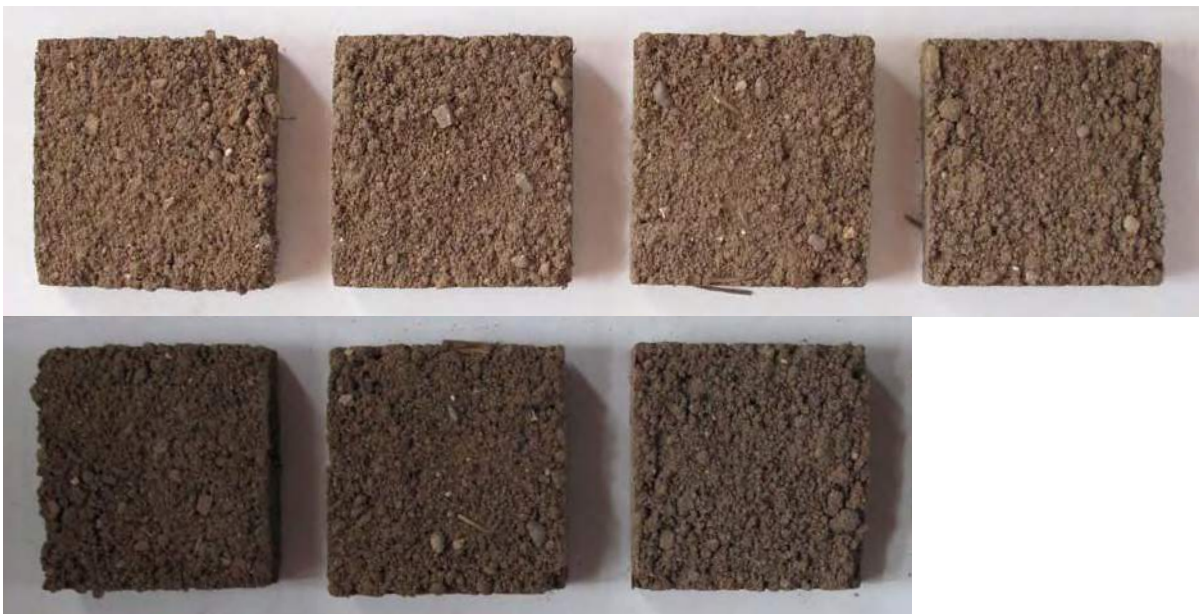
Figura VI.25. Probetas realizadas con tierra de Guiniguada estabilizada homogéneamente con arena procedente de Tufia en proporciones idénticas de gránulos. Dimensiones: 4 x 14 x 14 centímetros. (Procedencia gráfica: Díaz, I).
