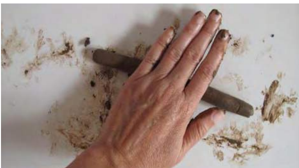
Figuras VI.19 y VI.20. Ensayo de la cinta; determina la plasticidad de un suelo. (Procedencia gráfica: Díaz, I.)
