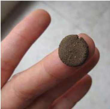
Figuras VI.17 y VI.18. Ensayo del cordón en el que se aprecian las fisuras en el borde de la bola. (Procedencia gráfica: Díaz, I.)
