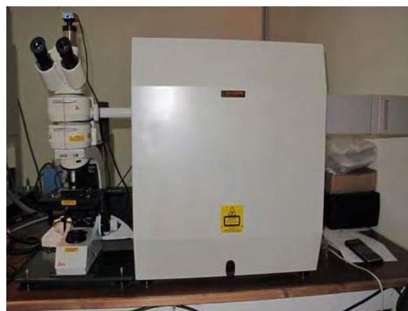
Figuras VII.20 y VII.21. Haz de luz roja apuntando a la muestra e imagen general del Espectrómetro Ramán. (Procedencia gráfica: Díaz, I.).
