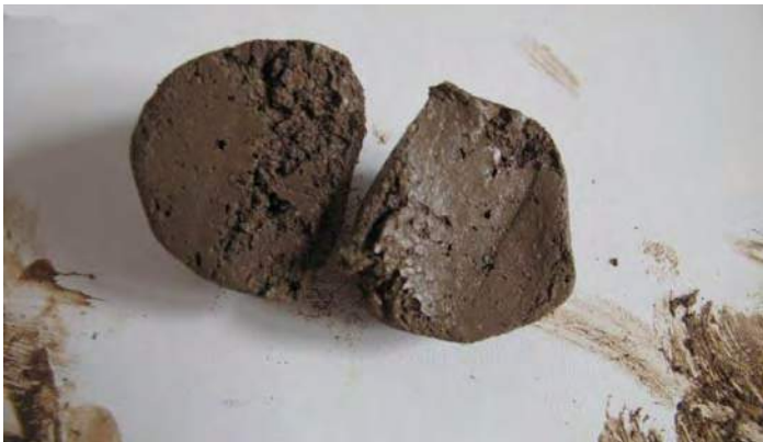
Figuras VI.9 y VI.10. Aspecto brillante de la bola una vez cortada, indicadora de una tierra arcillosa (Procedencia gráfica: Díaz, I.).
