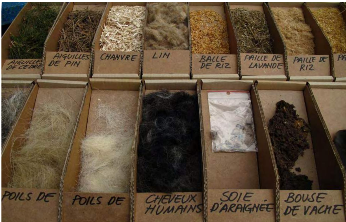
Figura 0.7. Sustancias naturales empleadas comunmente en la mejora de embarrados. (Procedencia gráfica: Díaz, I.).
