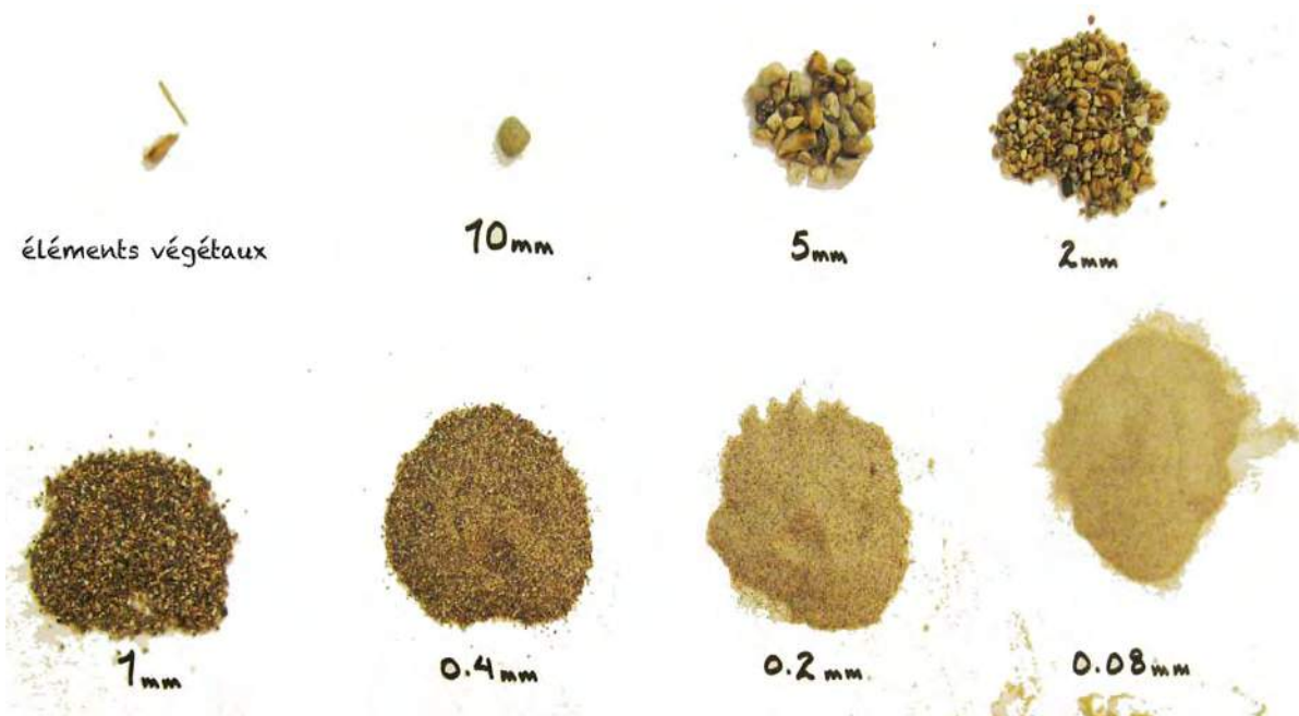
Figura VI.6. Tierra cribada en diferentes tamices, lo que permite apreciar a simple vista la sección granulométrica y porcentajes de granos constituyentes de un suelo determinado (Procedencia gráfica: Hau, S.; Alvarez, N. y Leylaverigne, E.).
