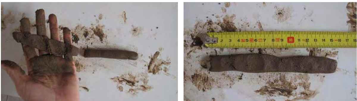
Figuras VI.21 y VI.22. Test de la cinta que ha dado como resultado un suelo arcillo-limoso al producirse la rotura de la cinta sobre los 15 centímetros. (Procedencia gráfica: Díaz, I.).
