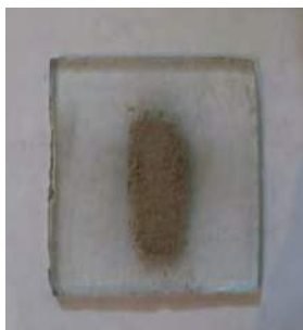
Figura VII.26. Fijación de la muestra. (Procedencia gráfica: Díaz, I.).
