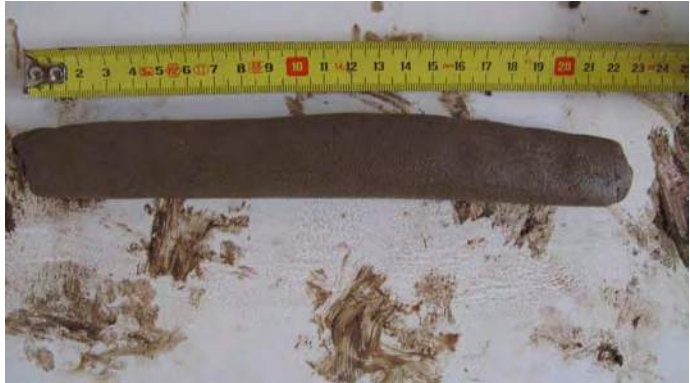
Figura VI.13. Realización del rollo con la medida específica para el ensayo: 20 centímetros (Procedencia gráfica: Díaz, I.).
