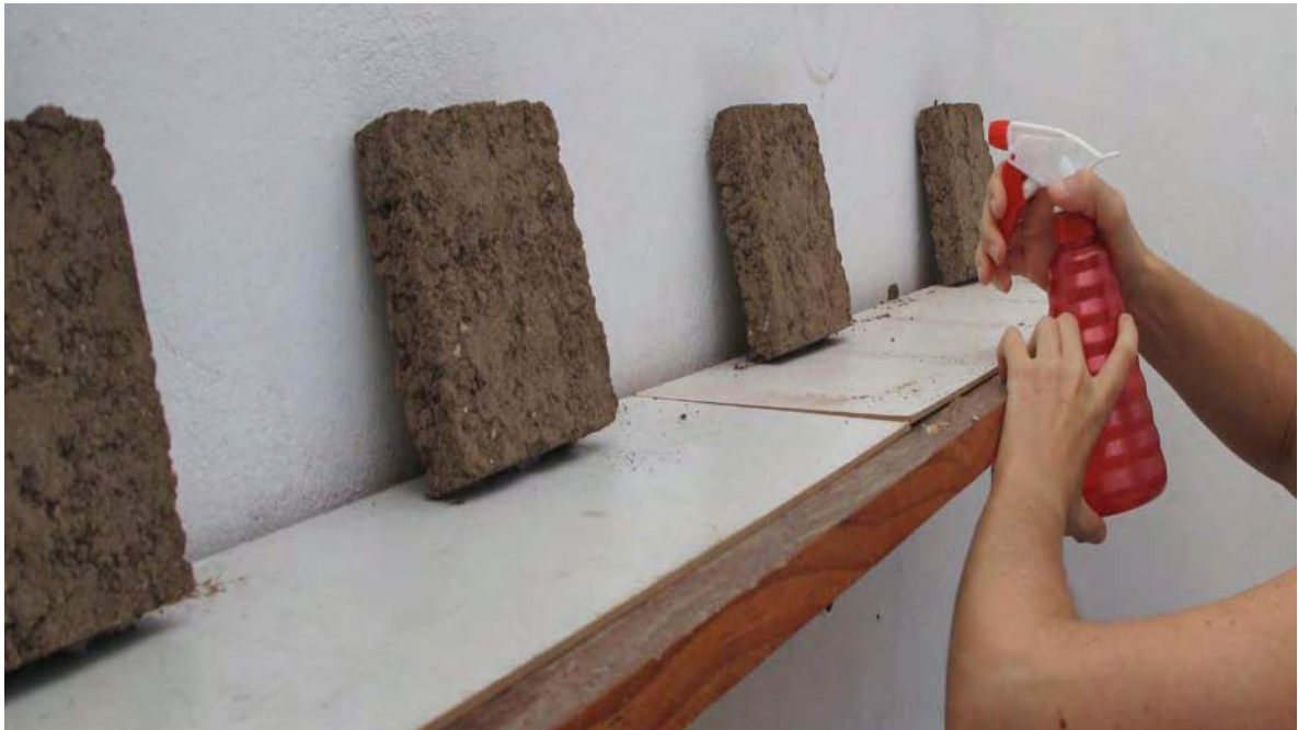
Figura VI.26. Proceso de consolidación de probetas. (Procedencia gráfica: Díaz, I.).
