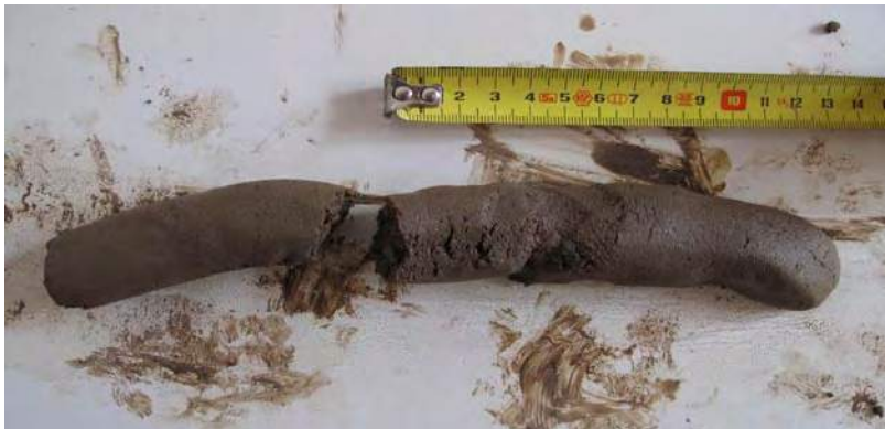
Figura VI.16. Resultado del test del rollo en el que la muestra analizada ha roto a los 120 mm: tierra óptima para ser empleada en tapial. (Procedencia gráfica: Díaz, I.).
