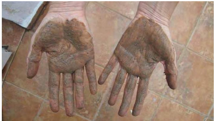
Figura VI.8. Test de lavado de manos en el que se aprecia la coloración y cohesión de la muestra de tierra (Procedencia gráfica: Díaz, I.).
