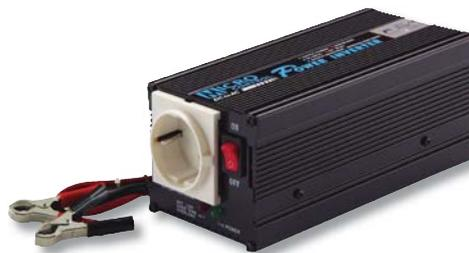
Wechselrichter für max. 300 W Leistung mit Überlastanzeige (LED) und Ventilator zur Kühlung. Für einzelne 230 V Geräte, wie z.B. portable TV Geräte, kleine Stereoanlagen, Videorecorder, Elektronikwerkzeuge und auch größere Lötkolben, Heißklebepistolen, Kühltaschen, Beleuchtung, als 230 V Bordnetz für kleine Wohnwagen, Camper und kleinere Boote.
