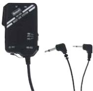
**Densei MV-509** Multi Vox System mit Gürtelclip. Freisprecheinrichtung für PMR 446 Geräte. Die Vox-Empfindlichkeit ist stufenlos regelbar. Anschluss: 2,5/3,5 mm Buchsen zur Aufnahme diverser Headsets aus unserem Lieferprogramm. Anschlussmöglichkeit für externe Sendetaste (PTT).
