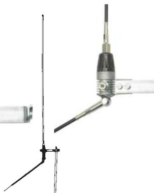
Lambda 1/2 Balkon/Stationsantenne mit 2 Wendelstrahlern. SWR-Abgleich mittels Abstimmstift an beiden Strahlern. Inkl. Montagematerial.
