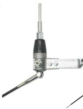
Lambda 1/4 Balkon/Stationsantenne. Der Aluminiumstrahler hat eine Länge von 300 cm. SWR-Abgleich mittels Abstimmstift am unteren, kurzen Strahler. SWR: <1,2
