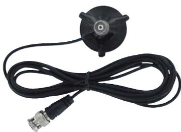
Mini-Magnetfuß (Ø 35 mm) mit enormer Haftkraft. Mit BNC-Anschluss zur Aufnahme von Gummiwendel- und kürzeren Stabantennen. Am 2,40 m langen, verlustarmen RG 174 Anschlusskabel ist ein BNC-Stecker montiert.
