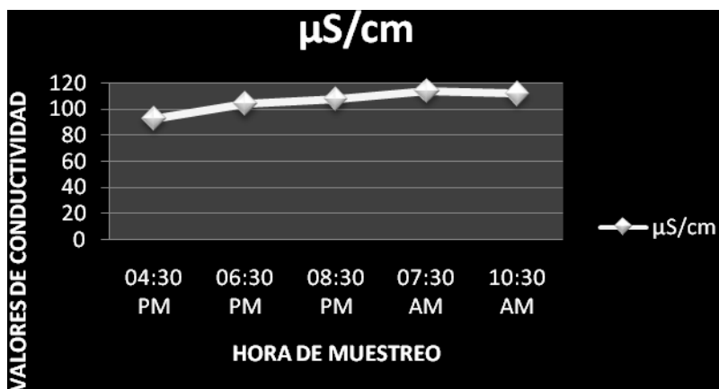
Figura No. 28. Parámetros de Conductividad para Estanque No. 2
