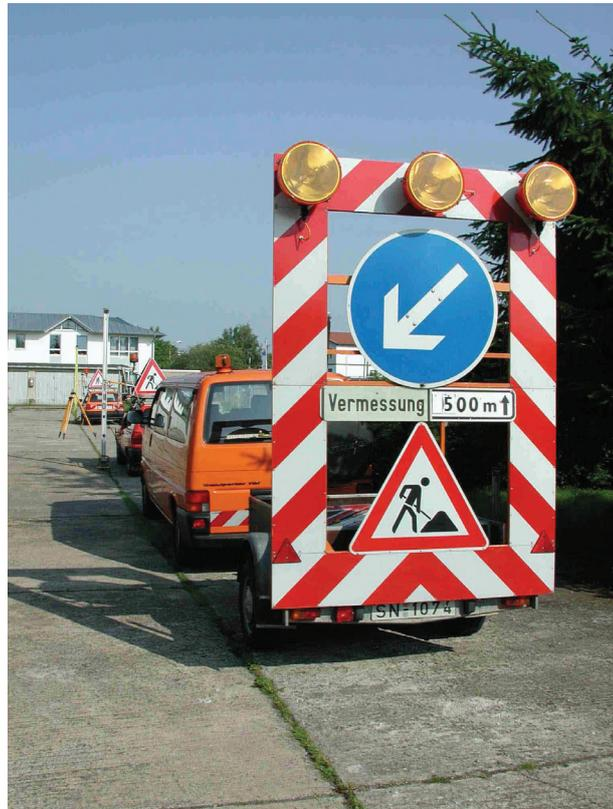
Abbildung 33: Sicherungsfahrzeug VW T4 mit Sicherungsanhänger
