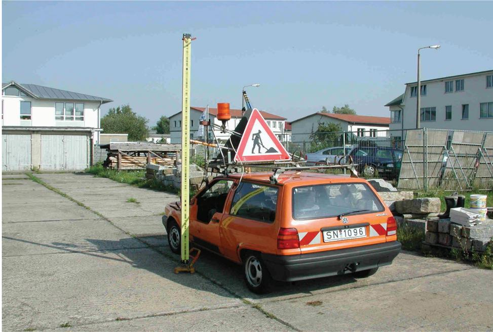
**Abbildung 21: Lattenfahrzeug VW Polo, Messstellung**
