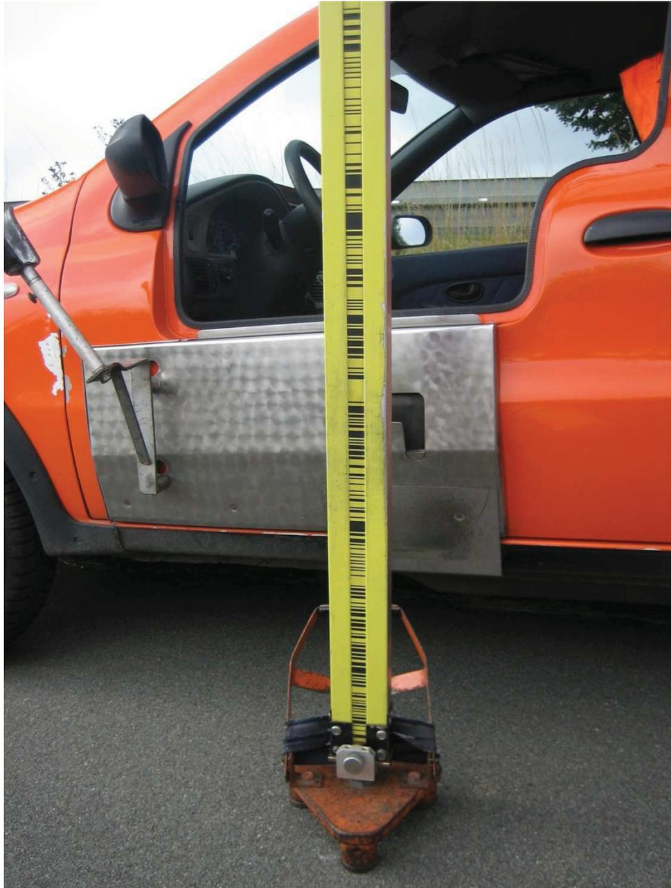
**Abbildung 26: Lattenfahrzeug, Nivellierlatte, Lattenuntersatz, Lattenschuh**
