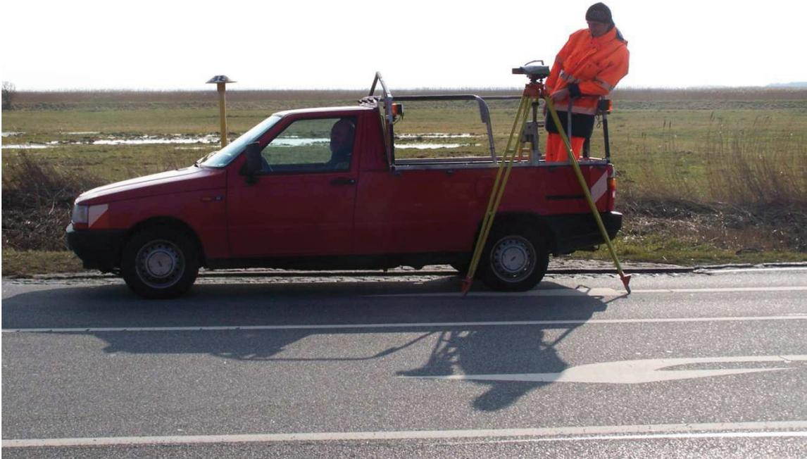
**Abbildung 13: Instrumentenfahrzeug, Beobachter und Stativ in Messstellung**
