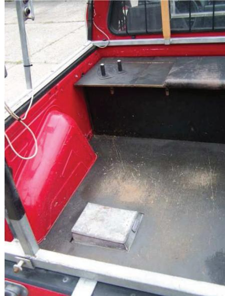
Abbildung 15: Bodendurchbruch geschlossen
