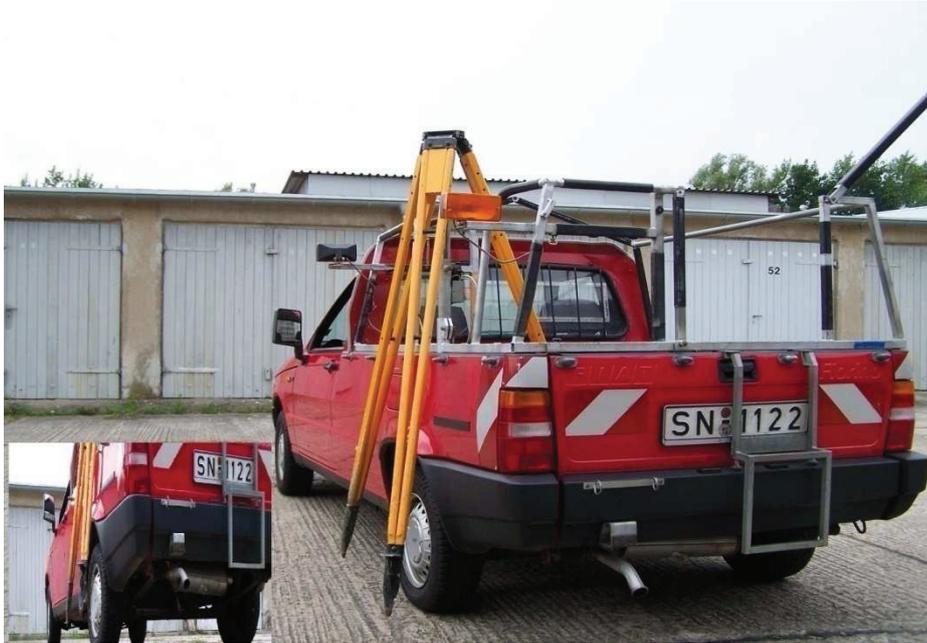
Abbildung 37: Stativ in Transportstellung Standpunktwechsel
