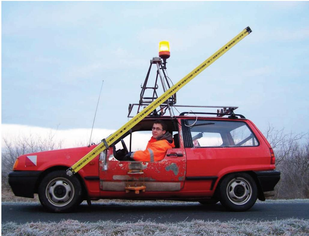
**Abbildung 27: Lattenfahrzeug VW Polo, modifizierte Fahrertür**
