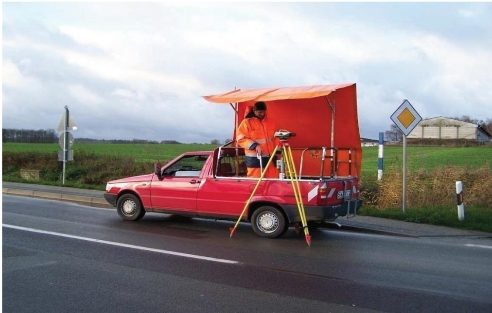
Abbildung 18: Instrumentenfahrzeug während der Messung, Wetterschutz
