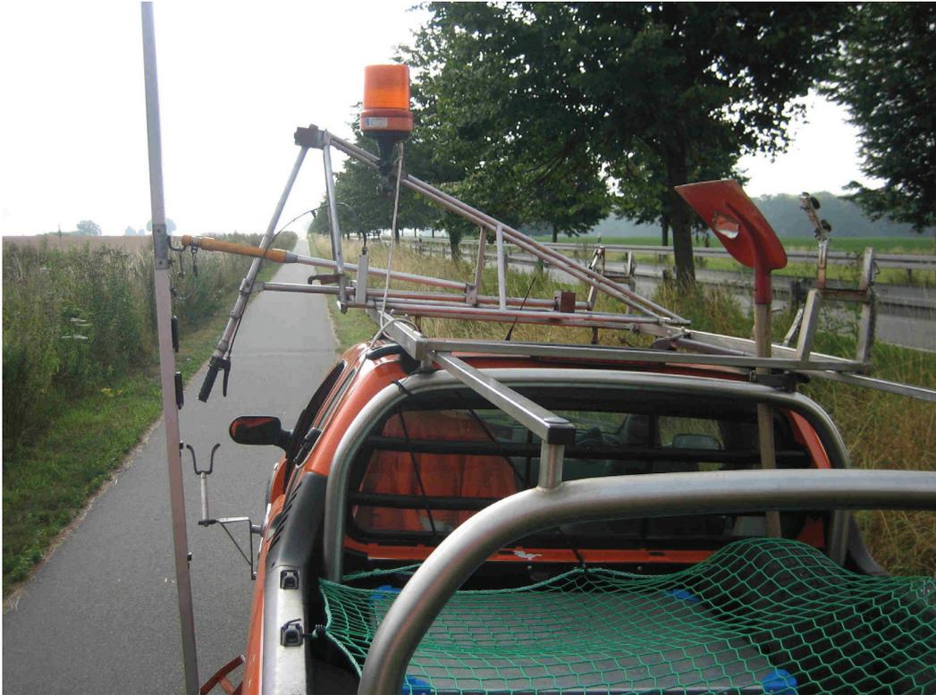
Abbildung 35: Dachaufbau mit Haltegestell und Steuereinrichtung
