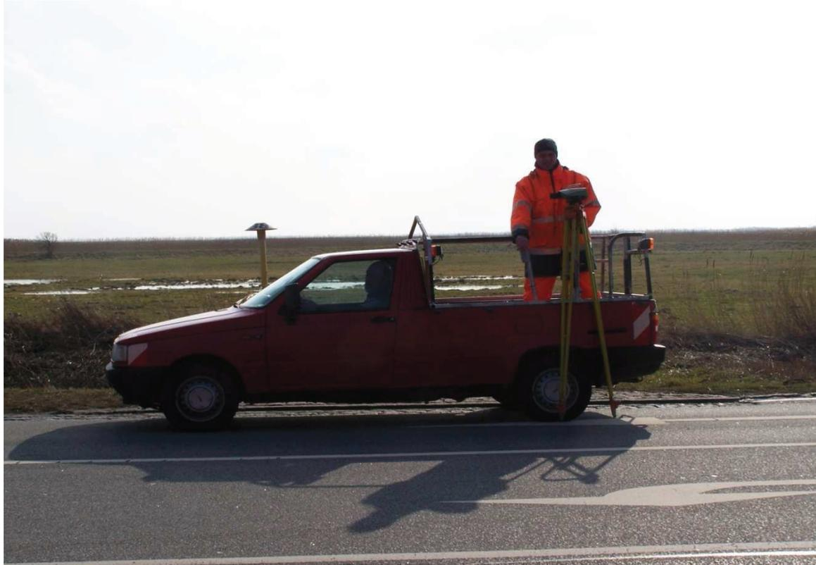
**Abbildung 16: Instrumentenfahrzeug, Stativ in Transportstellung Standpunktwechsel**
