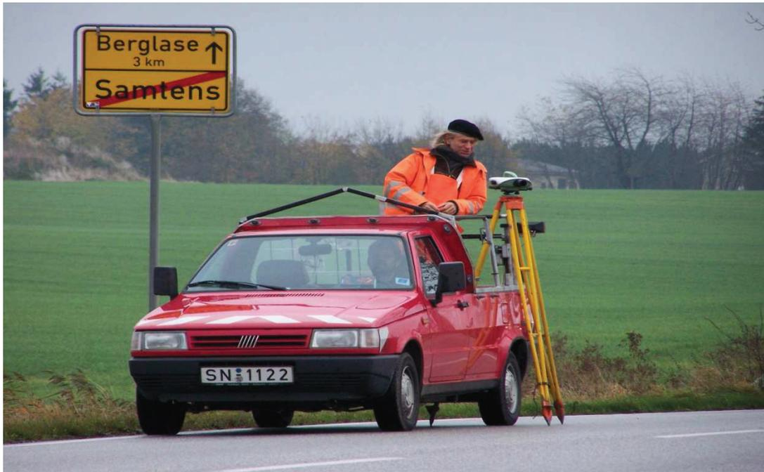
Abbildung 11: Instrumentenfahrzeug mit Beobachter und Instrument in Messstellung
