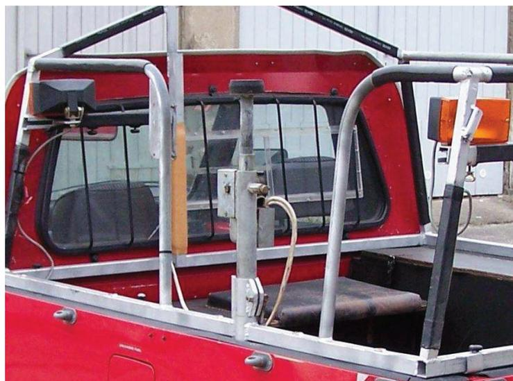
**Abbildung 17: Instrumentenfahrzeug, Hubvorrichtung**
