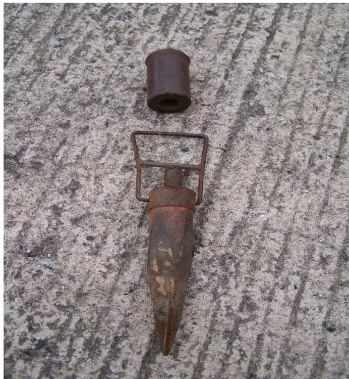
Abbildung 34: Eisennagel mit Schlagkappe
