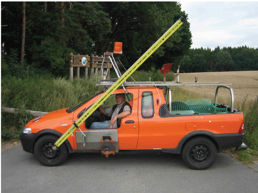
Abbildung 20: Lattenfahrzeug Fiat Strada, Transportstellung Messung
