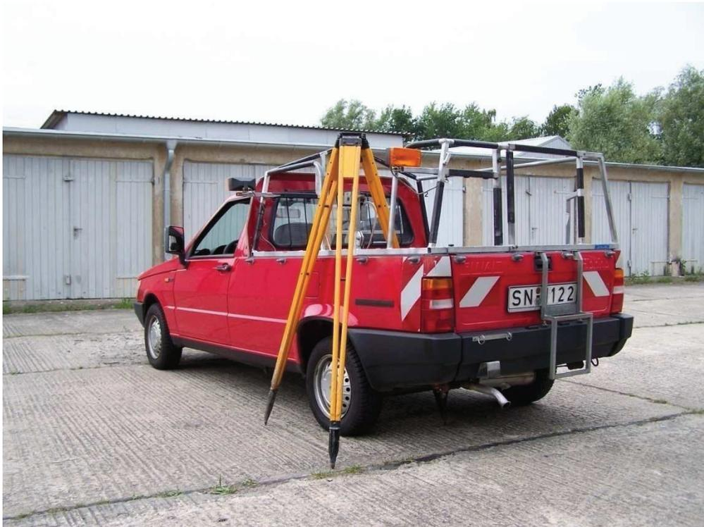
**Abbildung 36: Stativ in Messstellung**
