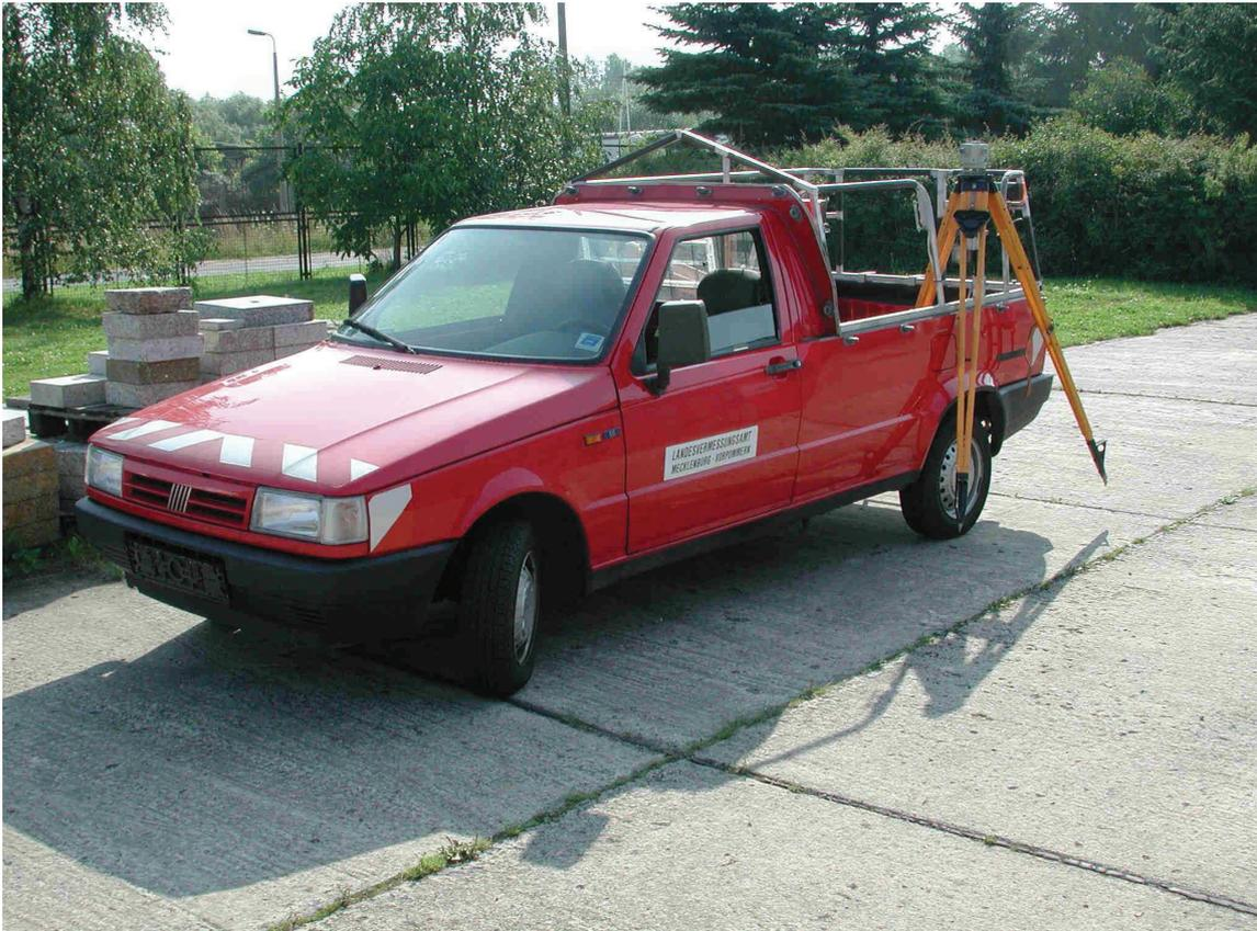
Abbildung 10: Instrumentenfahrzeug Fiat Fiorino, Stativ in Transportstellung Standpunktwechsel
