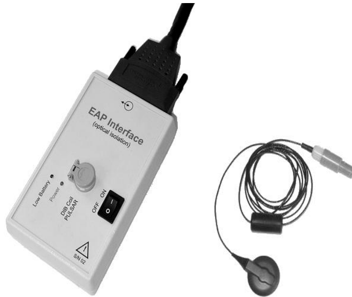
Figura 3.2: Interface (izquierda) y bobina (derecha) utilizados en el sistema EAPRS.
