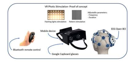
Fig. 1. VR-Photosense prototype
