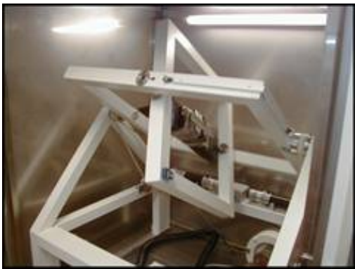
Figura 23. La Random Positioning Machine (RPM) del Centro ESTEC de la ESA en Noordwijk (Holanda) con unas muestras colocadas en el area central de microgravedad simulada.
