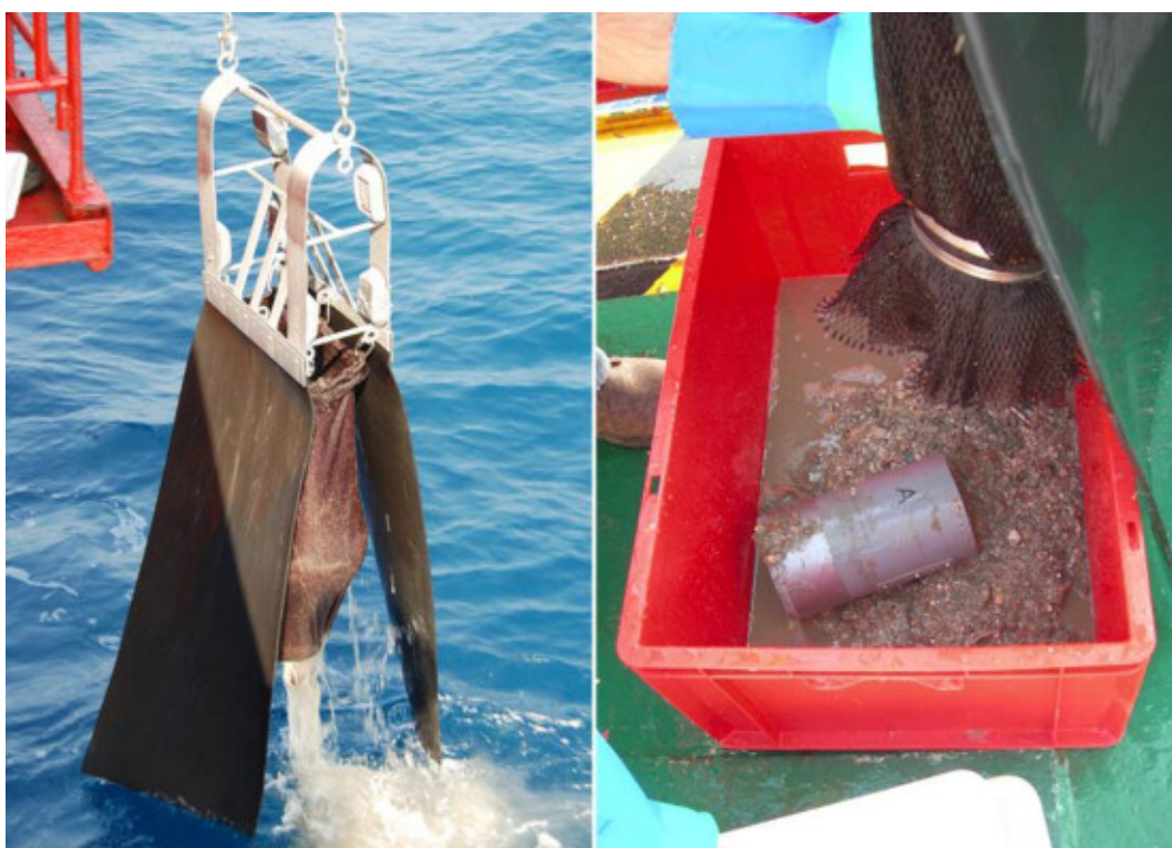
Figura 3.5.1.- Draga Rauschert. Actúa como un patín, deslizándose sobre el fondo y recolectando los organismos de la macrofauna bentónica que queda dentro de un depósito de malla. Una vez a bordo los ejemplares más de mayor tamaño son seleccionados a mano y el resto de la muestra es lavado y reprocesado sucesivamente en función de su diámetro.
