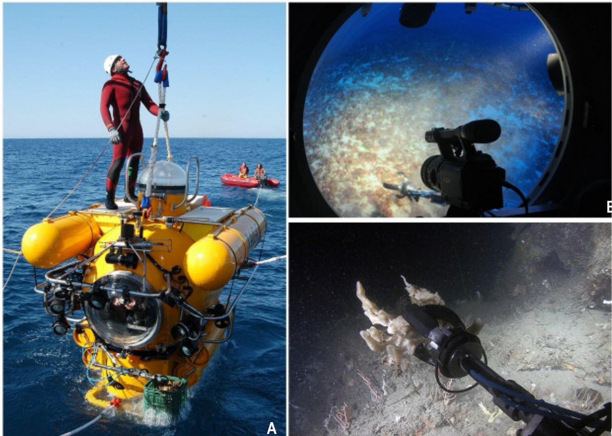
Figura 3.2.3.- El trabajo con un submarino tripulado tiene una serie de condicionantes logísticos particulares y requiere de unas excelentes condiciones de mar. Especialmente críticas son las maniobras de largado y de izado a bordo. Para ambas se requiere la presencia de un buzo profesional (el “hookman”), responsable liberar o asegurar el submarino al cable de la grúa del B.O. una vez que se han comprobado todos los protocolos de comunicaciones y de seguridad (A). El submarino cuenta con una cámara de alta resolución y un brazo articulado (B) que permite la recogida de muestras y su transporte en un cestillo acoplado (C).
