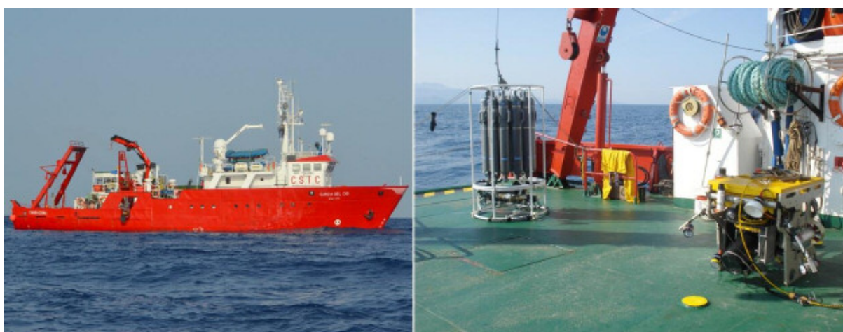
Figura 3.1.1.- Imagen del B.O. García del Cid gestionado por la Unidad Técnica Marina (UTM) del CSIC y detalle de la cubierta cuya extensión y disposición permiten el uso de vehículos submarino e instrumental de tamaño medio, gracias a la presencia de pórtico y de un completo sistema de grúas.
