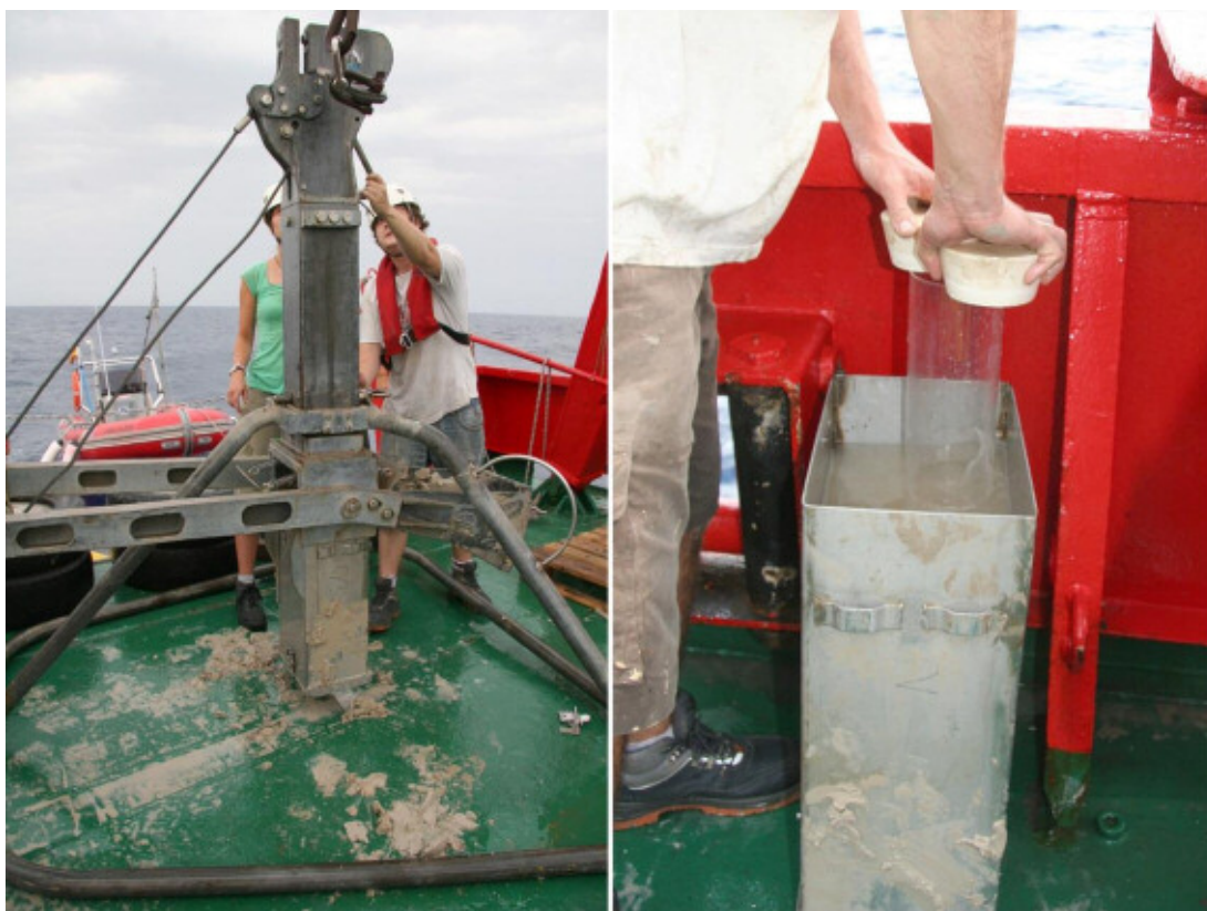
Figura 3.4.1.- Sacatestigos de caja (izquierda). De la muestra de sedimento que se extrae se obtienen dos submuestras de sedimento de 10 cm de diámetro y hasta 20 cm de largo (derecha) por estación. De esta manera se pueden estudiar los sedimentos depositados sobre el lecho marino sin apenas perturbación del fondo.
