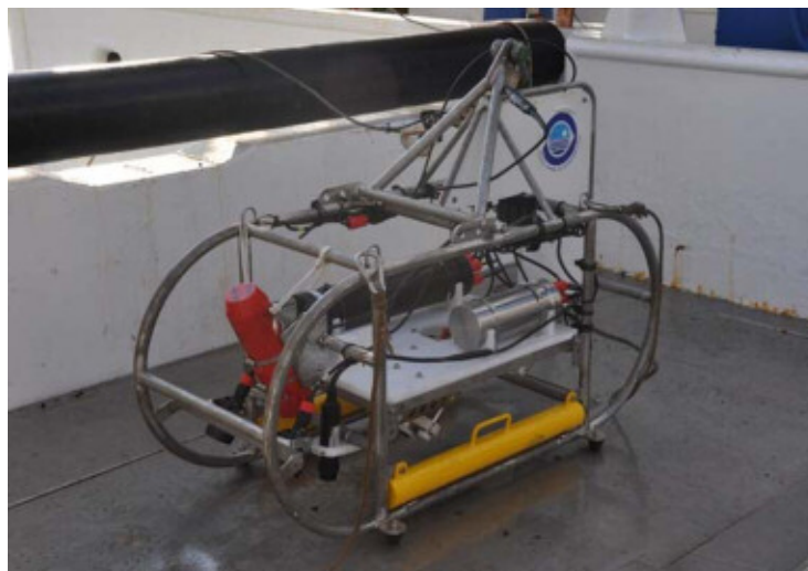
Foto 10. Trineo fotogramétrico Politolana
