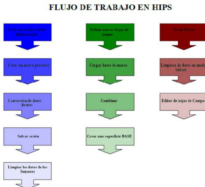
Figura 12.- Flujo de trabajo en el entorno de Caris HIPS and SIPS para el procesado de las sondas obtenidas con ecosonda multihaz.
