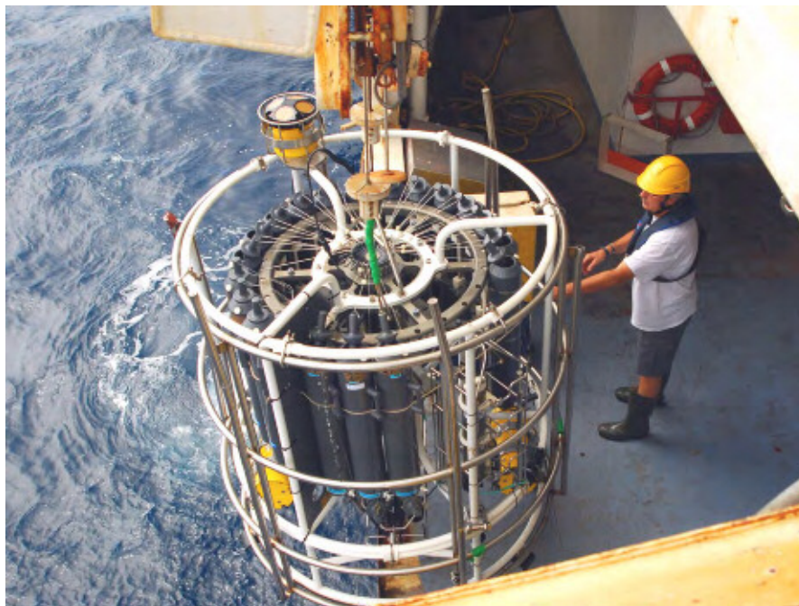
Figura 4.2.2. Recuperando la roseta de 24 botellas desde el pórtico de hidrografía del B/O ss durante la campaña INDEMARES 0710.
