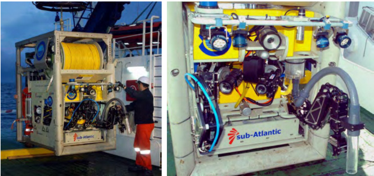
Figura 4.10.1- A) Recuperación del ROV ro s , situado en el interior de su TMS, y B) detalle de la disposición de cámaras y focos durante la campaña A0412.
