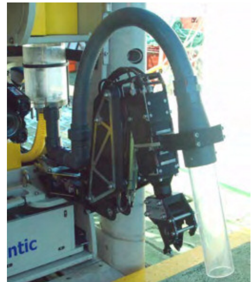
Figura 4.10.2.- A) Brazo manipulador de 6 grados de libertad ro e HLK-47000 (a la izquierda) para la captura de ejemplares vivos y B) sistema de succión acoplado al manipulador ro e HLK-HD45 de 5 funciones (a la derecha).
