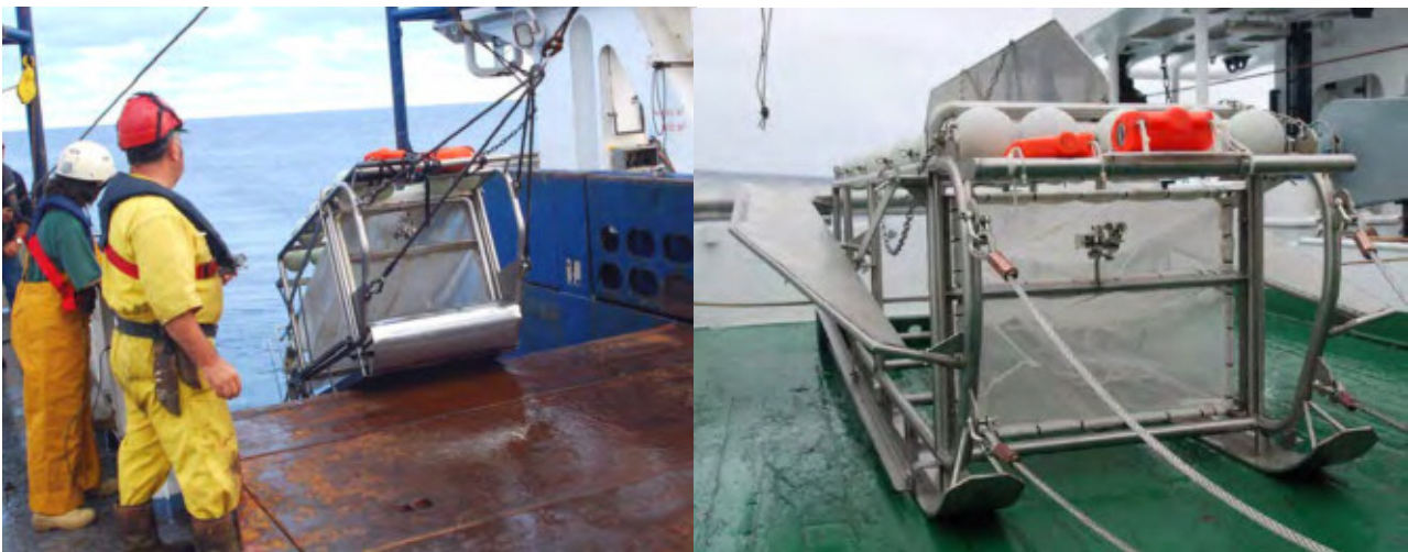
Figura 4.6.1.- Los dos tipos de trineos suprabentónicos utilizados en las campañas INDEMARES. Izquierda: campaña INDEMARES-AVILÉS 0710; derecha: campaña INDEMARES-AVILÉS 0511. Los sensores Scanmar (profundidad y distancia al fondo) se sitúan en la parte superior delantera del trineo.
