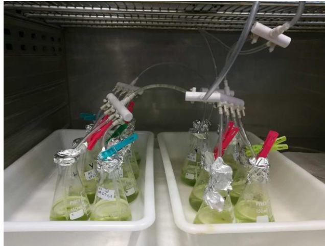
Figura 5. Diseño experimental utilizado, detalle del montaje dentro de la cámara termostatzada mantenida a 25°C. Fuente: elaboración propia.
