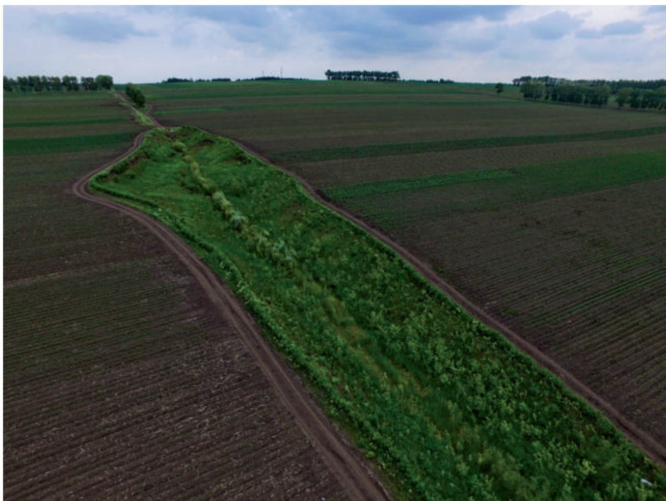
Figura 3.2.7.2. Medidas de vegetación para el control de cárcavas en la región de suelo negro del noreste de China (FotoL. Meng).
