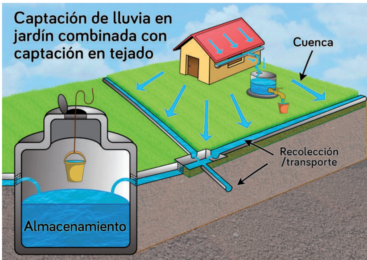
Figura 3.2.12.5. Estrategias para la recolección de escorrentía en los tejados, arriba, y en los jardines, abajo. Adaptado de Studer y Liniger (2013).
