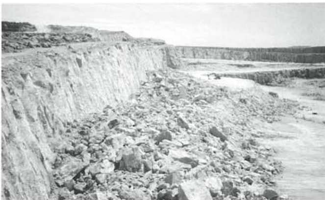
Fig. 8. Resultado de la voladura de una sola fila.
