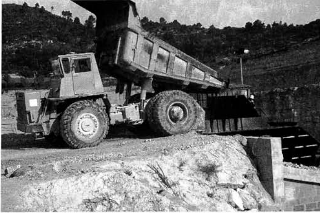
Fig. 12. Descarga del mineral en la tolva de recepción.
