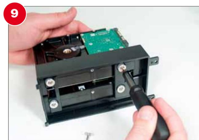
**9** Bauen Sie die Laufwerkskäfige aus dem Gehäuse aus. Schrauben Sie Festplatten mit je zwei Schrauben pro Seite fest. Ideal sind Schraub- und Befestigungssysteme, die die Festplatte vom Käfig entkoppeln, sodass sich die Schwingungen nicht auf das Gehäuse übertragen.
