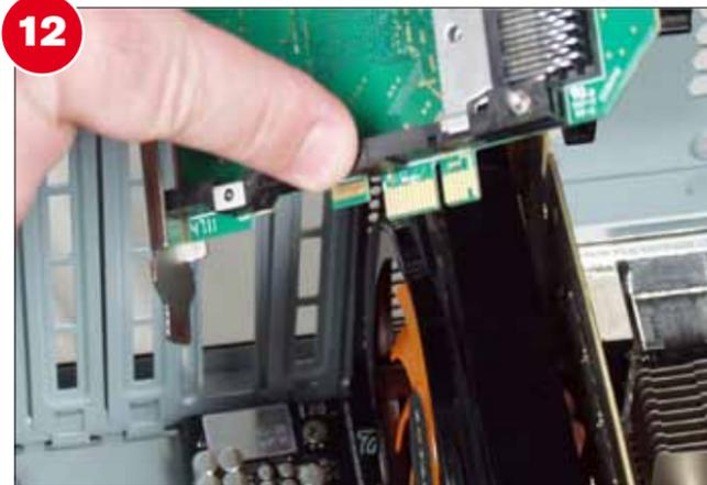
**12** TV-Karte einbauen: Falls der passende Slot fehlt, können Sie alle x1- und viele x4-PCI-Express-Karten auch in einem x16-Steckplatz betreiben. Entfernen Sie die Abdeckung des ausgewählten Schachtes, drücken Sie die TV-Karte hinein, und schrauben Sie sie fest.
