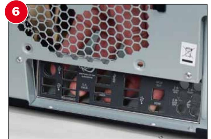
**6** Setzen Sie die Schnittstellenblende der Platine ins Gehäuse ein. Prüfen Sie, ob auf dem Gehäuseboden die Abstandshalter-Schrauben richtig positioniert sind, sodass für jede Bohrung in der Hauptplatine eine Schraubenfassung zur Verfügung steht.
