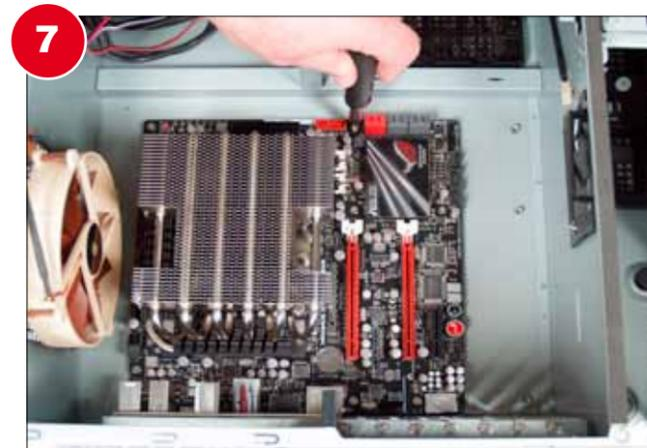
**7** Drücken Sie das Schnittstellenfeld der Platine vorsichtig in die Blende hinein. Setzen Sie die Befestigungsschrauben jeweils abwechselnd diagonal ein, bis sie fassen. Erst wenn die Hauptplatine sauber in die korrekte Position gerutscht ist, ziehen Sie alle Schrauben fest an.
