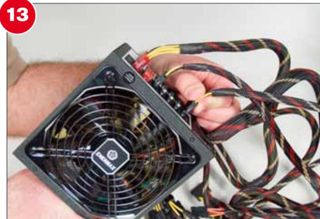
**13** Netzteil vorbereiten: Modulare Netzteile haben den großen Vorteil, dass Sie nur die Kabelstränge anstecken, die Sie wirklich benötigen. Lediglich die 24polige Hauptleitung sowie die quadratischen 4poligen 12-Volt-Stecker für die CPU sind immer fest installiert.
