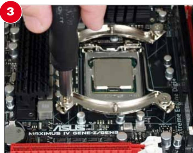
**3** Lesen Sie die Montageanleitung des CPU-Kühlers genau durch. In der Regel stecken Sie von unten eine Metallplatte (Backplate) mit 4 Stiften durch die Bohrungen am CPU-Sockel. Dann legen Sie Abstandsbolzen auf die Stifte und schrauben die Backplate mit Querstreben fest.
