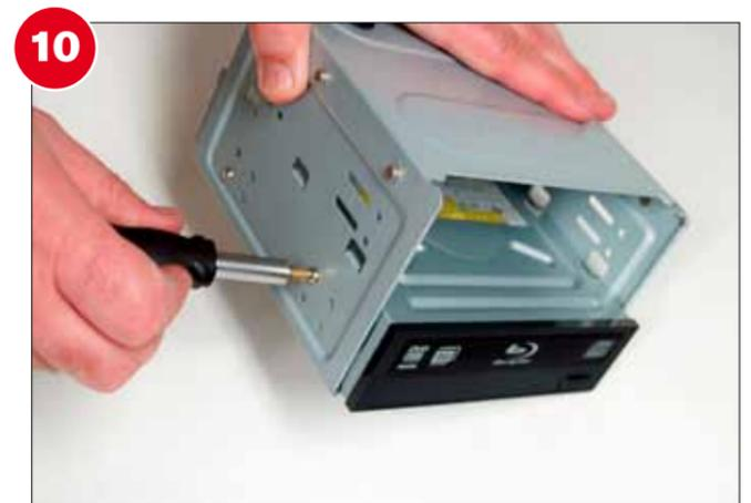
**10** Blu-ray-Brenner: Ein optisches Laufwerk kann in einem leisen PC die Haupt-Lärmquelle sein. Hier ist die Entkopplung vom Gehäuse noch viel wichtiger als bei Festplatten. Wenn Ihr Gehäuse keine entsprechende Dämpfung besitzt, können Sie diese auch später nachrüsten.
