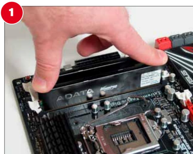
**1** Arbeitsspeicher einsetzen: Legen Sie die seitlichen Halterungen am Speicher-Steckplatz nach außen, und drücken Sie das Speichermodul an beiden Enden gleichzeitig nach unten, bis es einrastet. Den schnellen Zwei-Kanal-Modus nutzen Sie, wenn Sie beide Steckplätze bestücken.
