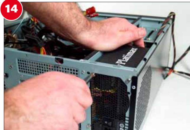
**14** Netzteil einbauen: Prüfen Sie vor der Montage, ob der Netzteil Lüfter am Lüftergitter des Gehäuses zu liegen kommt. Schrauben Sie dann das Netzteil mit den vier beiliegenden Schrauben an den korrespondierenden Bohrungen im Gehäuse fest.
