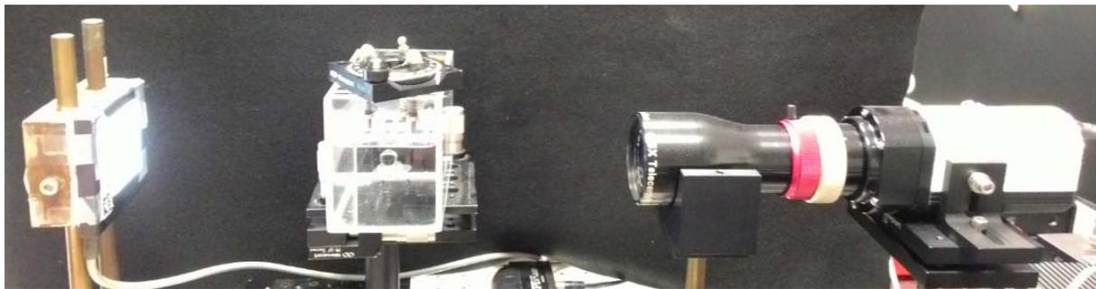
**Figura 2.3.** Sistema experimental que contiene la fuente de retro-iluminación difusa (izquierda), cubeta (centro) y sistema telecéntrico con cámara CCD (derecha).
