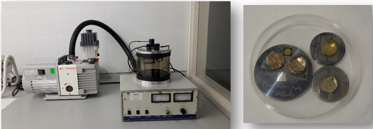
Figura 30. A) unidad CC7650 SEM Carbon Coater B) Muestras recubiertas con carbón.
