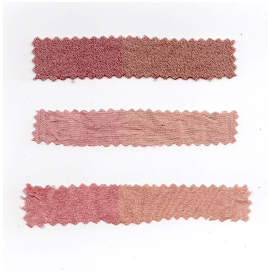
Imagen 46. Muestras después del ensayo de solidez a la luz. Elaboración propia
