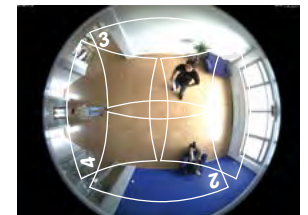
Vier virtuelle PTZ-Kameras aus einer einzigen 360° Hemispheric-Kamera
