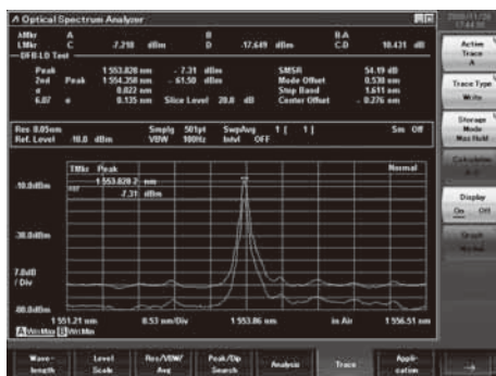
Max Hold, Min Hold Display Function
