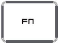
Beim Drücken der „FN“-Taste in Verbindung mit den Funktionstasten werden die sekundären Funktionen aktiviert.
