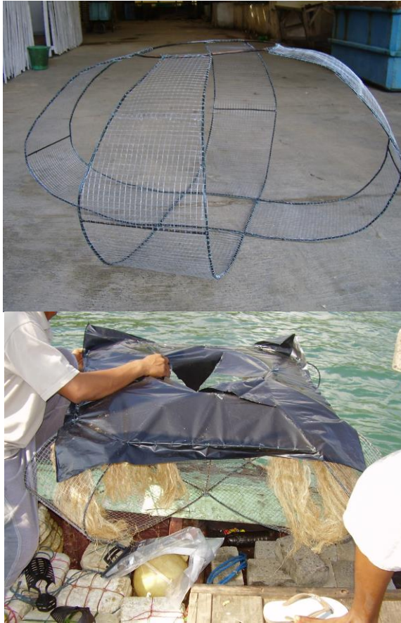
Gambar 12. Konstruksi atraktor cumi-cumi yang diteliti di Pelabuhan Ratu
