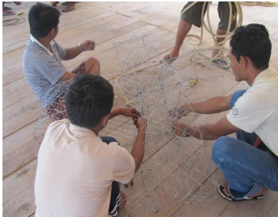
Gambar 7. Pemasangan kawat seng (panjang 45 cm) dan pemasangan pagar pada bagian tengah badan atraktor
