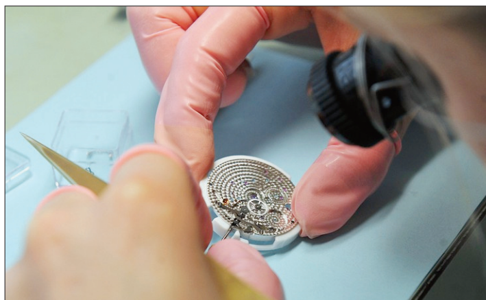
À L'ÉTABLI Le mouvement automatique BSE1325-A, ici au montage, peut fonctionner près de 80 heures sans être remonté. (CHRISTIAN GALLEY)
