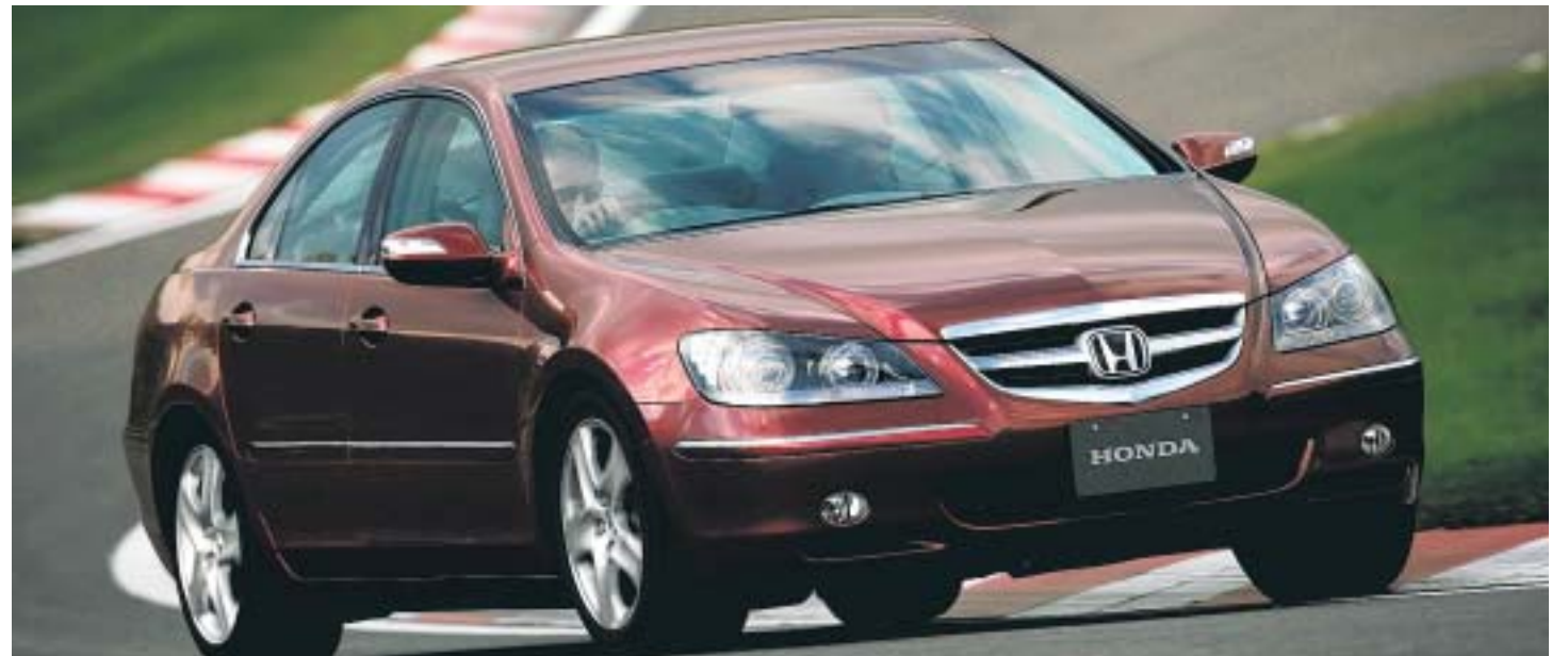
La nouvelle Honda Legend – ici dans sa version japonaise – est la première voiture équipée d'une traction intégrale «active». Dans les virages, c'est la roue arrière extérieure qui accélère.
