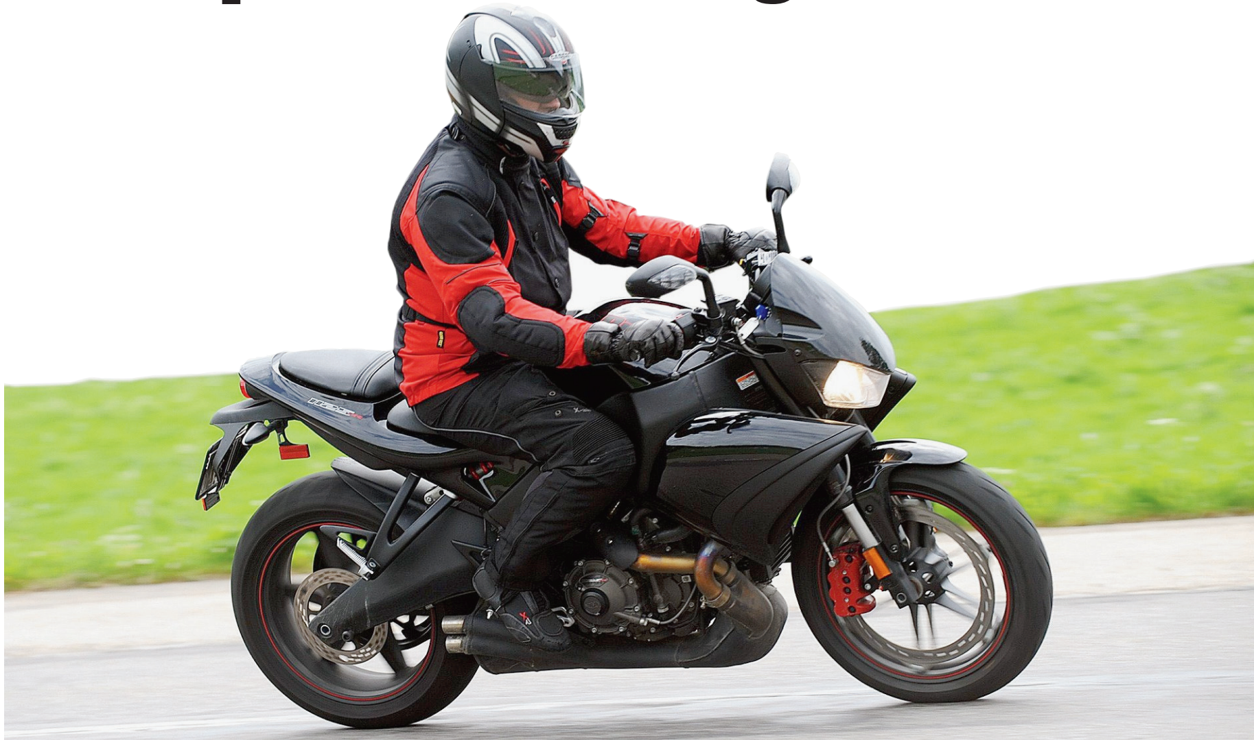
BUELL 1125 CR Un seul gros disque de frein sur la roue avant et un pot d'échappement très ramassé sous le moteur font partie des particularités de ce roadster.
