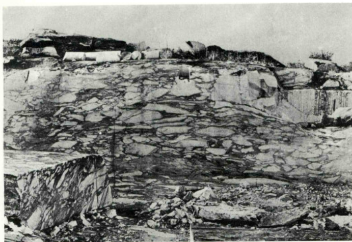
Fig. 1 — Aspecto dos mármore calcíticos do nível superior da série carbonatada que, embora de fraca qualidade, são aproveitados como pedra ornamental. Este aspecto, pouco comum, é devido à deformação de leitos heterogêneos e de resistências diferentes.
