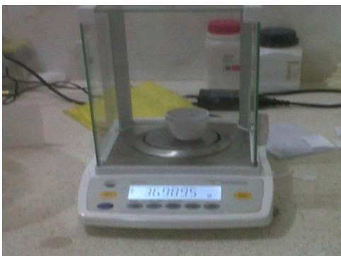
Pesar por tres veces los crisoles con la muestra hasta obtener pesos constantes
