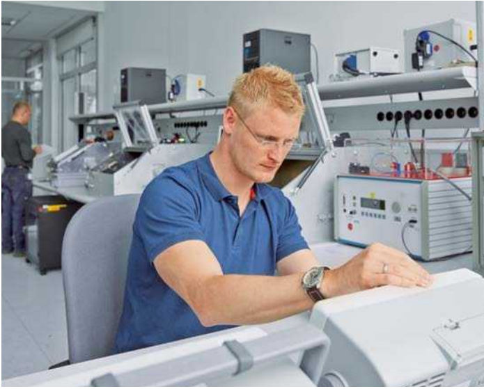
Abb. 26: Vollautomatisierte Prüfanlage zur Bestimmung des Überlast- und Ausfallverhalten von Überspannungs-Schutzgeräten gemäß IEC 61643-11 [6]
