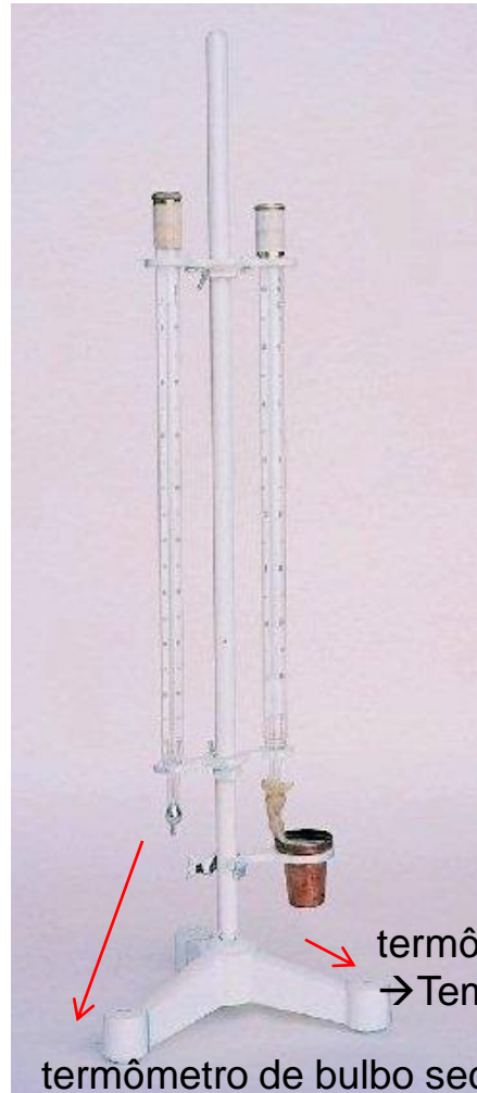
Psicrômetro sem movimentação de ar
