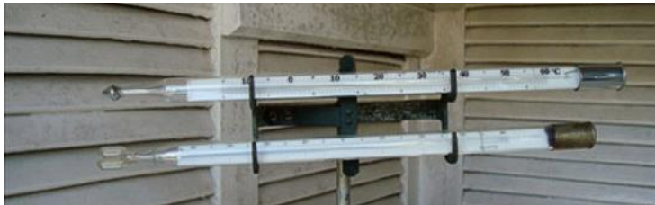
Termômetro de máxima (em cima) e Termômetro de mínima (em baixo)
