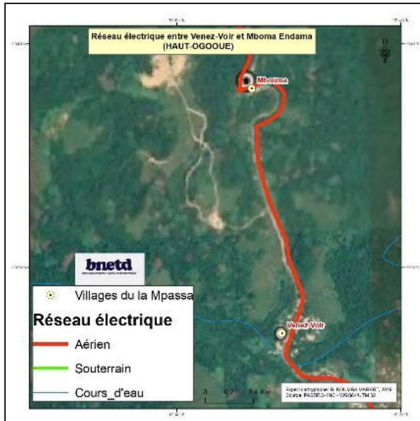
Figure 8- Axes pour les travaux d'extension et de renforcement des lignes HTA/BT aérienne
