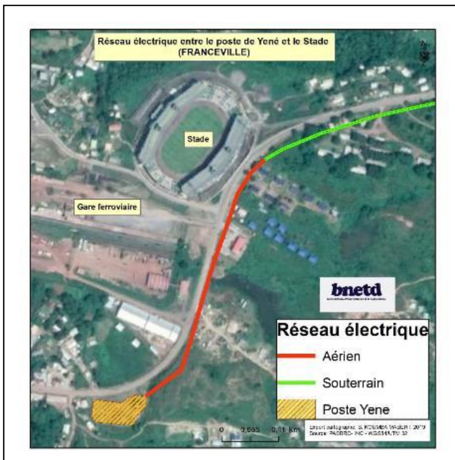
Figure 4-Axes pour les travaux d'extension et de renforcement des lignes HTA/BT souterraine à Franceville
