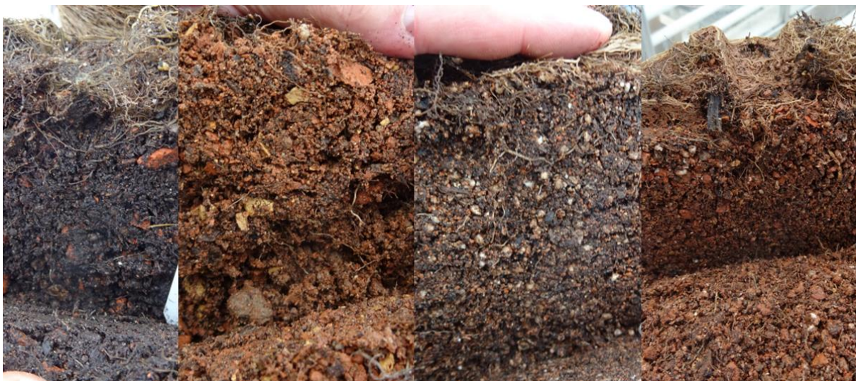
Figur 8-9. Vertikalt snitt gjennom nederste halvdel av jordklump for et utvalg av pottene i Figur T2. Fra venstre: Østfoldgresss sin intensive takjord, blanding 16, blanding 4, blanding 15.
