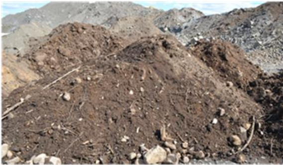
Jordmasser med stein og blokk fra anleggsprosjekter
