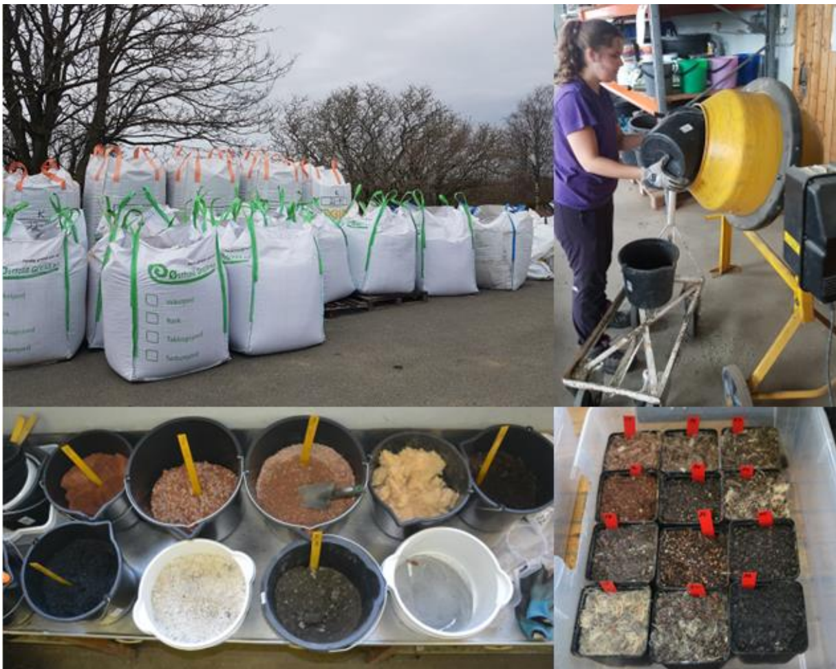
Figur 8-1. Bilder fra oppstartsfasen med storesekker med råvarene, system for blanding av komponentene, en oversikt over noen av råvarene (nede tv) og noen av de første testblandingene (nede th).
