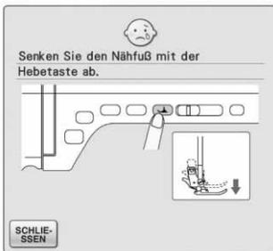
Diese Anzeige erscheint, wenn eine Taste, wie z. B. die Taste „Start/Stopp“, bei angehobenem Nähfuß gedrückt wird.
