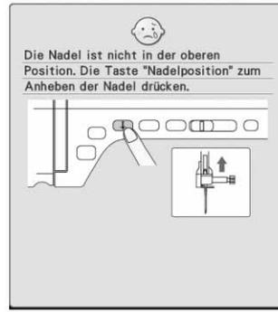
Diese Meldung erscheint, wenn Sie die Nähmaschine nach dem Anschließen der Stickeinheit wieder einschalten und die Nadel abgesenkt ist.
