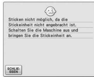
Diese Anzeige erscheint, wenn im Stick-Editiermodus die Taste „Start/Stop“ gedrückt wird, die Stickeinheit aber nicht installiert ist.
