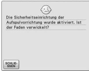
Diese Meldung erscheint, wenn der Motor beim Aufspulen des Unterfadens blockiert, weil der Faden sich verwickelt usw.
