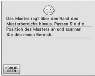
Diese Meldung erscheint, wenn die eingebaute Kamera zur Ausrichtung der Stickposition verwendet wird, der Stickpositions-Aufkleber aber zu nahe an einer Kante sitzt oder das Muster über den Stickrahmen hinausragt. Ändern Sie die Position des Stickpositions-Aufklebers und versuchen Sie dann erneut, die Position auszurichten. Siehe Seite 208.
