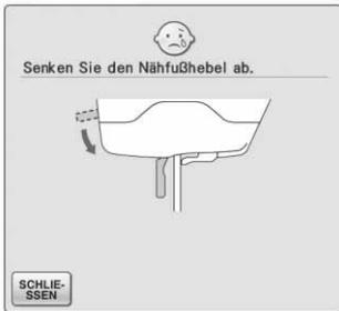
Diese Meldung erscheint, wenn Sie die Taste „Nähfußhebel“ drücken, während der Nähfußhebel angehoben oder die Nadel abgesenkt wird.
