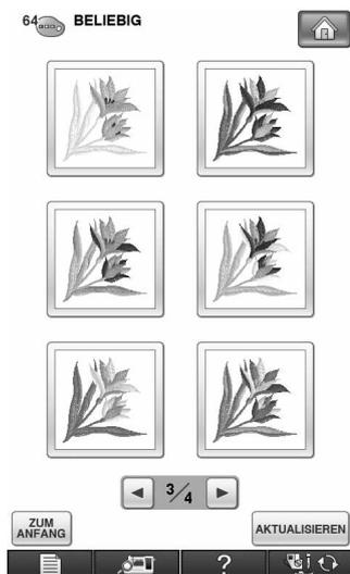
Mit der Funktion Color Shuffling (Zufällige Farbkombinationen) schlägt die Maschine für das gewählte Stickmuster neue Farbschemen vor. Wenn Sie den gewünschten Effekt aus einem der vier verfügbaren Farbschemen („BELIEBIG“, „INTENSIV“, „ABSTUFUNG“ und „WEICH“) wählen, wird ein Beispiel für den gewählten Effekt angezeigt.
