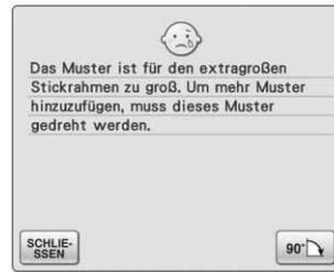
Diese Meldung erscheint, wenn im Stickmodus die Buchstabenkombination zu groß ist, so dass sie nicht in den Stickrahmen passt. Eine weitere Eingabe von Buchstaben ist möglich, wenn das Stickmuster um 90 Grad gedreht wird.
