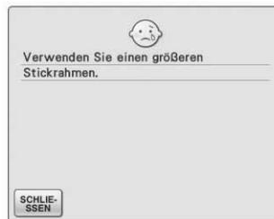
Diese Meldung erscheint, wenn im Stickmodus der kleine Stickrahmen angebracht ist und das gewählte Muster nicht in den kleinen Rahmen passt. Diese Meldung erscheint, wenn die Stickposition mit der eingebauten Kamera ausgerichtet wird, während der Stickrahmen (klein) eingesetzt ist.
