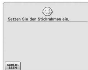
Diese Meldung erscheint, wenn die Maschine zum Sticken eines Musters bereit ist, und die Taste „Start/ Stopp“ gedrückt wird, ohne dass der Rahmen eingesetzt ist.
