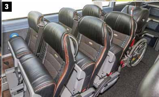
3 Verschiebbare Sitze machen Platz für ein bis zwei Rollstühle.
