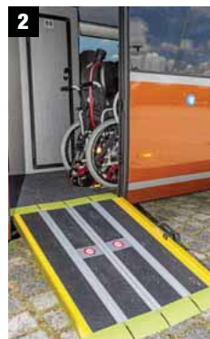
2 Eine faltbare Rampe lässt sich leicht im hinteren Einstieg montieren.
