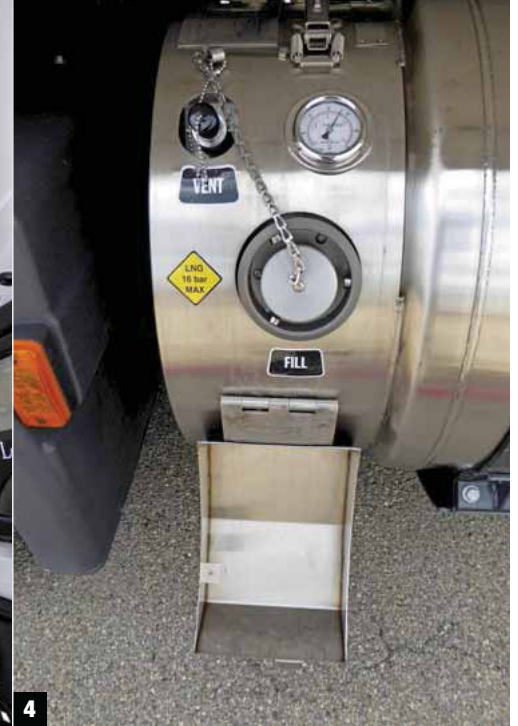
3 Über den CNG-typischen Galgen kann Erdgas bei Überdruck sicher entweichen. 4 Über genormte Stutzen wird der Tank mit LNG befüllt.
