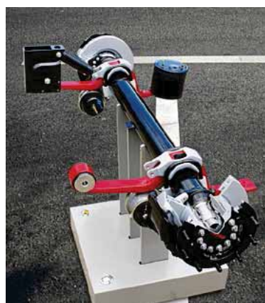
Die KTA-Achse von Kögel verfügt über zwei Federelemente.
