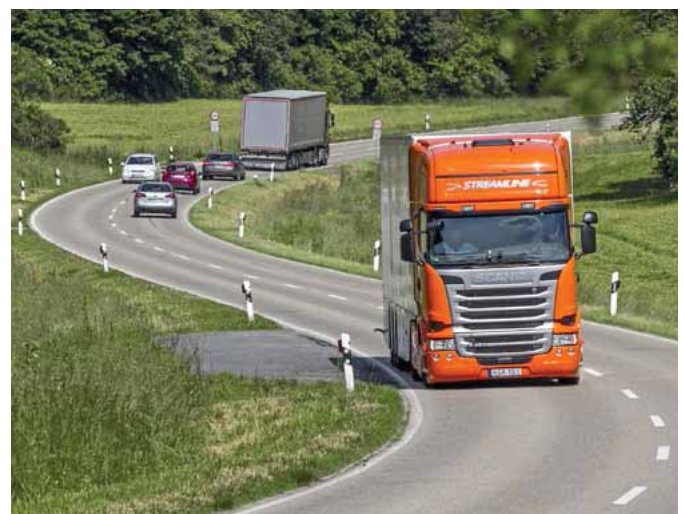
Der vorausschauende Tempomat wird bei Mercedes schon ab 15 km/h aktiv, bei Scania erst ab 50 km/h.
