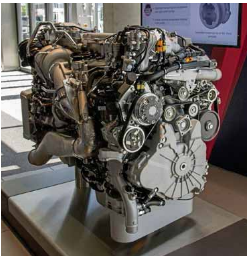
Der D26 kommt nun mit renoviertem Turbo und verbesserter Abgasrückführung daher.
